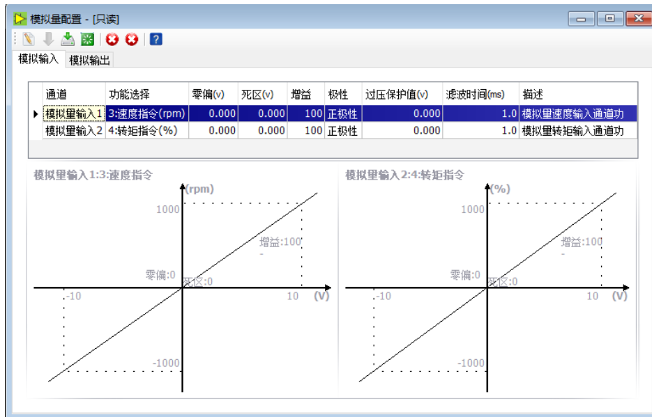
模拟量输入输出可以在图示中设定增益、零偏、死区等参数
