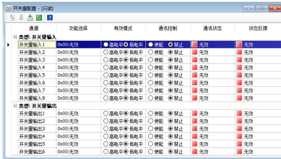
开关量输入、输出可以直接选择端子有效逻辑和功能分配
