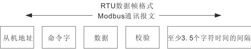
图 80 RTU 模式的通讯帧结构
