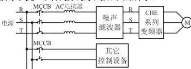
图 4-18 主回路电源侧连接图
