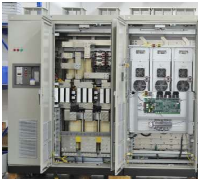
图 2-6 CHA 系列 PWM 整流器内部结构图（600kW：包括 600kW 整流柜） 注：从左到右依次为配电箱、600kW整流柜。
