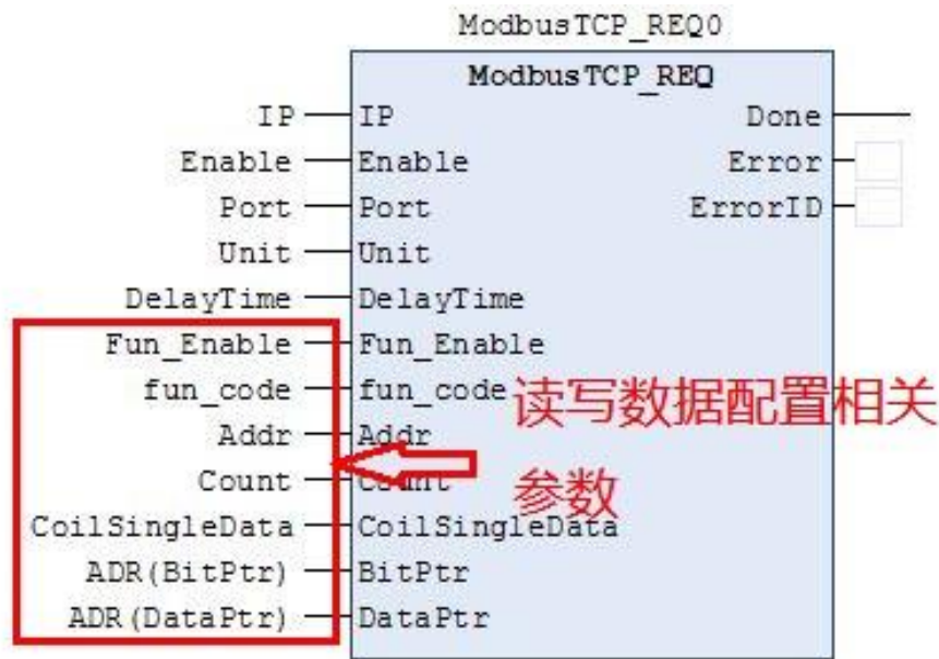
图 3.4 ModbusTCP_Master 主站和从站通信参数设置示例
