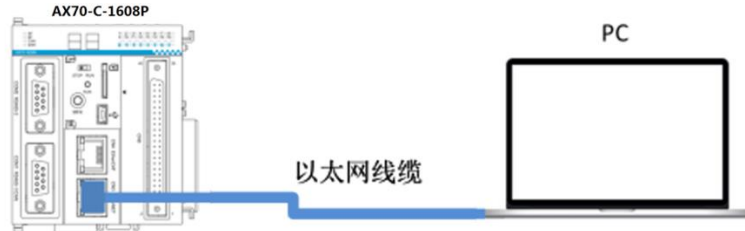
图 5-14 以太网连接示意图
