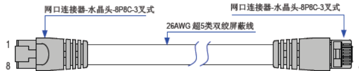
图 5-13 自制网线规格图
