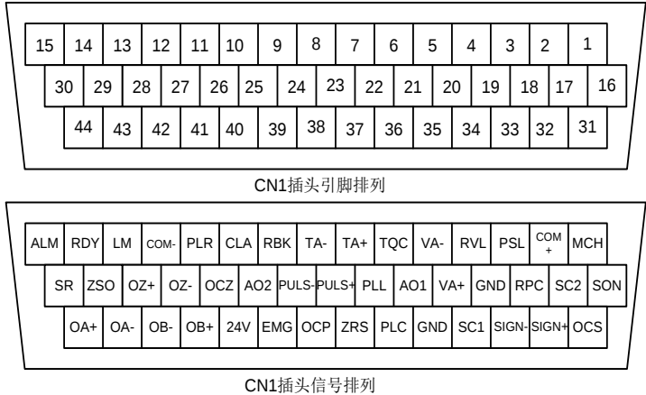
图 4-17 CN1 引脚信号图
