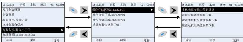
图 5-20 参数备份操作示意图
