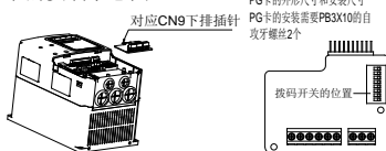
图 7-7 异步机 PG 卡安装示意图及外形尺寸
