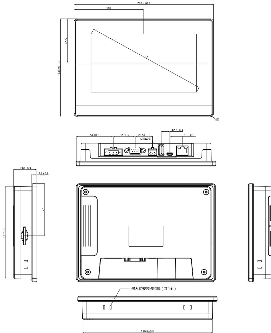
嵌入式安装开孔尺寸:  $192 \times 138 (+1.5\text{mm}/-0.0\text{mm})$
