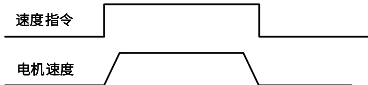
图6-19 软起动速度指令和电机速度
