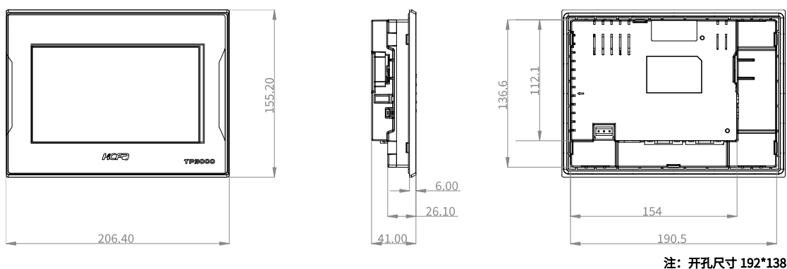
图 9 HC-TP3107-D 模块安装尺寸 (单位: mm)
