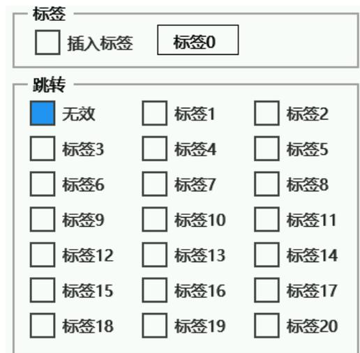
1. 插入标签：选中插入标签前面的复框，后面的标签名是系统自动生成。点击一次“插入”按钮，就把该标签插入到程序光标动作前面。
