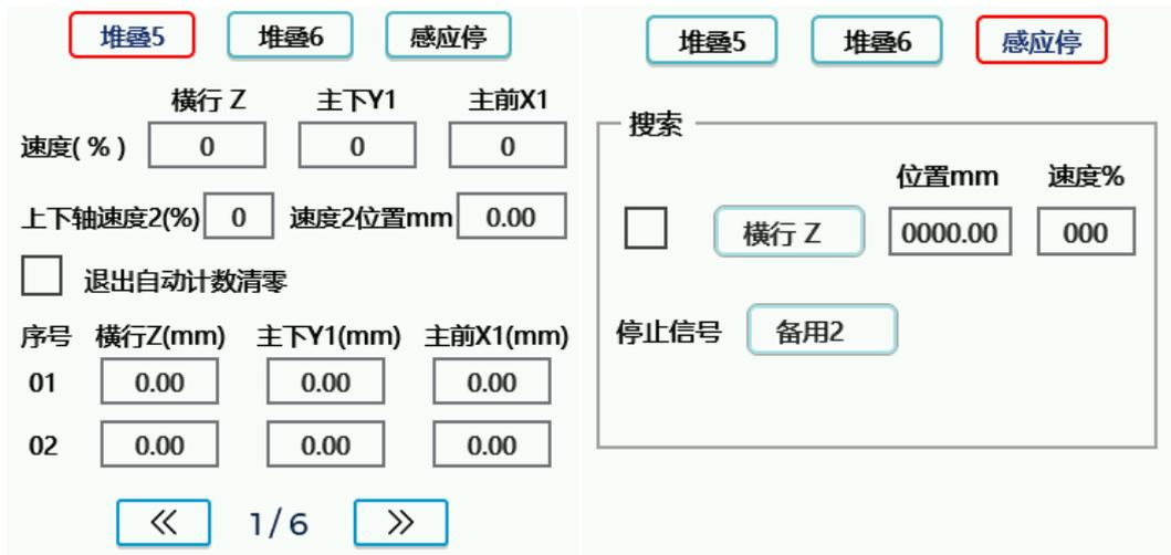
1. 感应停: 上图中点击“感应停”按钮, 如右图所示。轴以运行速度向最大位置运行, 当到达所设位置时, 以提前速度继续运行, 在运行期间, 感应到停止信号则停止运行。
