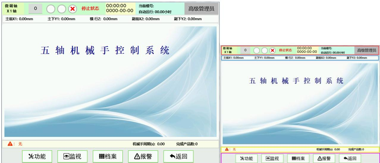
上图从上到下，主要分为五个功能显示区域，分别为状态栏(红色框)，位置显示栏(蓝色框)，主显示栏(没有标注框部分)，警报显示栏(黄色框)和功能操作栏(紫色框)。各显示区域详细说明如下：
