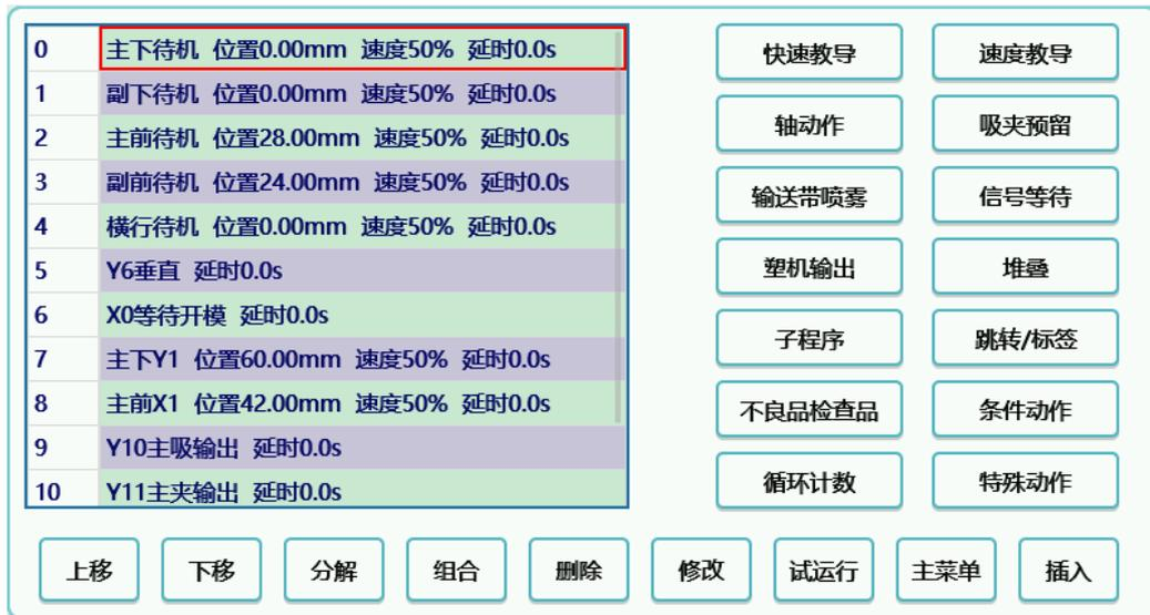
1. 教导动作显示：左侧部分的表格为教导动作显示区，显示所有教导的动作；
