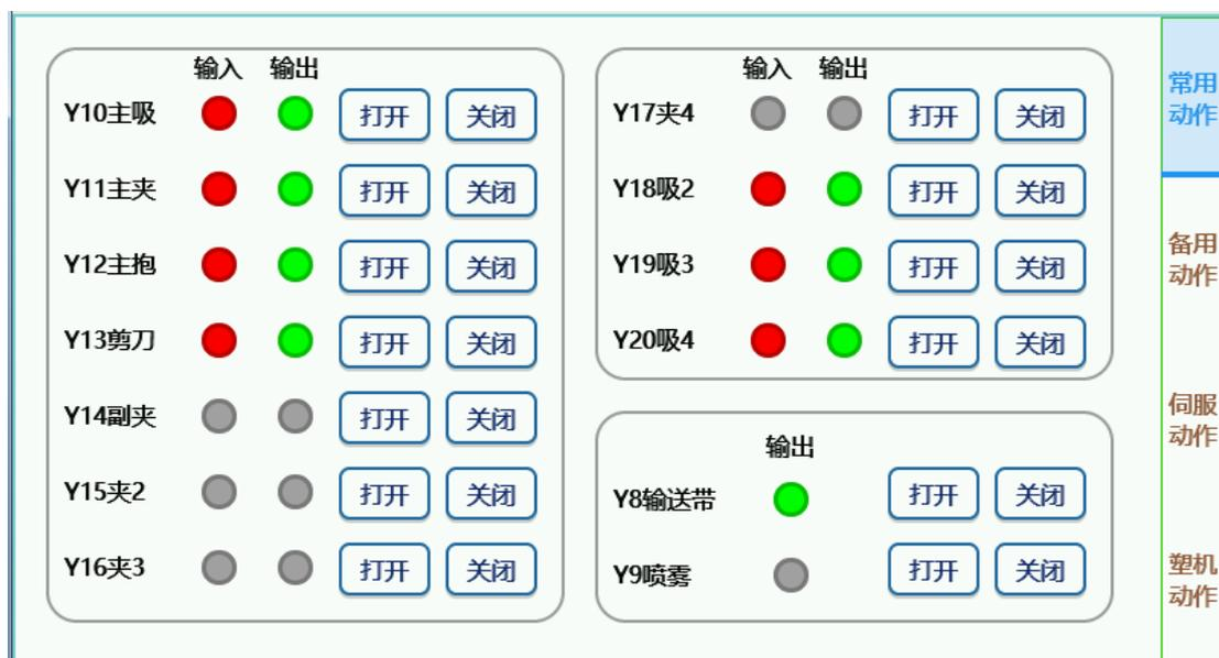
常用动作画面可以操作吸夹动作，剪刀动作，主抱动作，输送带，喷雾等等常用气动动作。点击“打开”按钮，会输出对应的动作，如果动作输出和反馈没有问题，对应的输出和输入信号灯也会打开；点击“关闭”，则关闭对应的动作输出。
