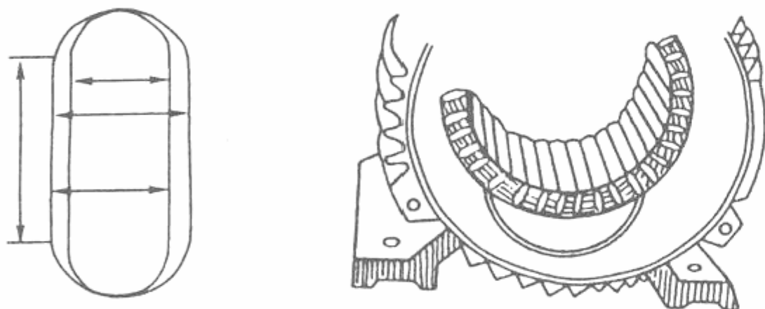
图 12-29 估测绕组的尺寸
