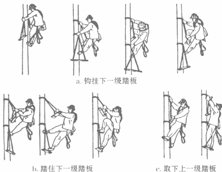
图 9-28 踏板下杆方法示意
