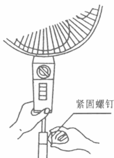
图 13-11 落地式电风扇扇头高度的调节方法
