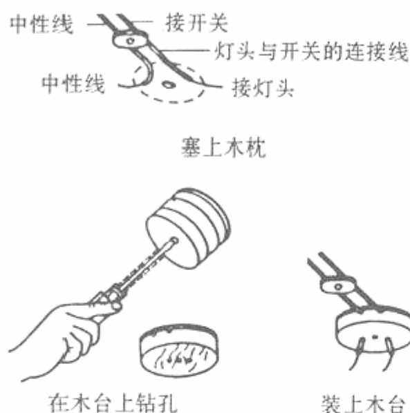
图 11-3 圆木的安装程序
