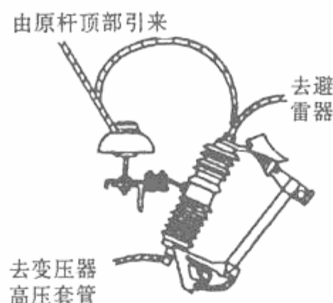
图 7-16 导线与跌落式熔断器的 接线示意
