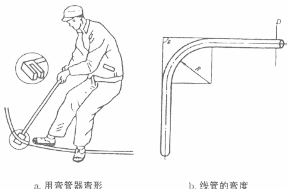
图 10-35 线管的弯形及弯度示意
