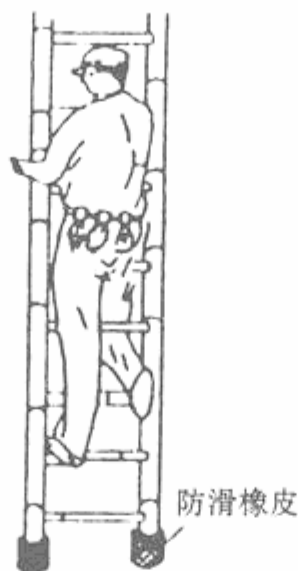
图1-8 梯上安全作业
