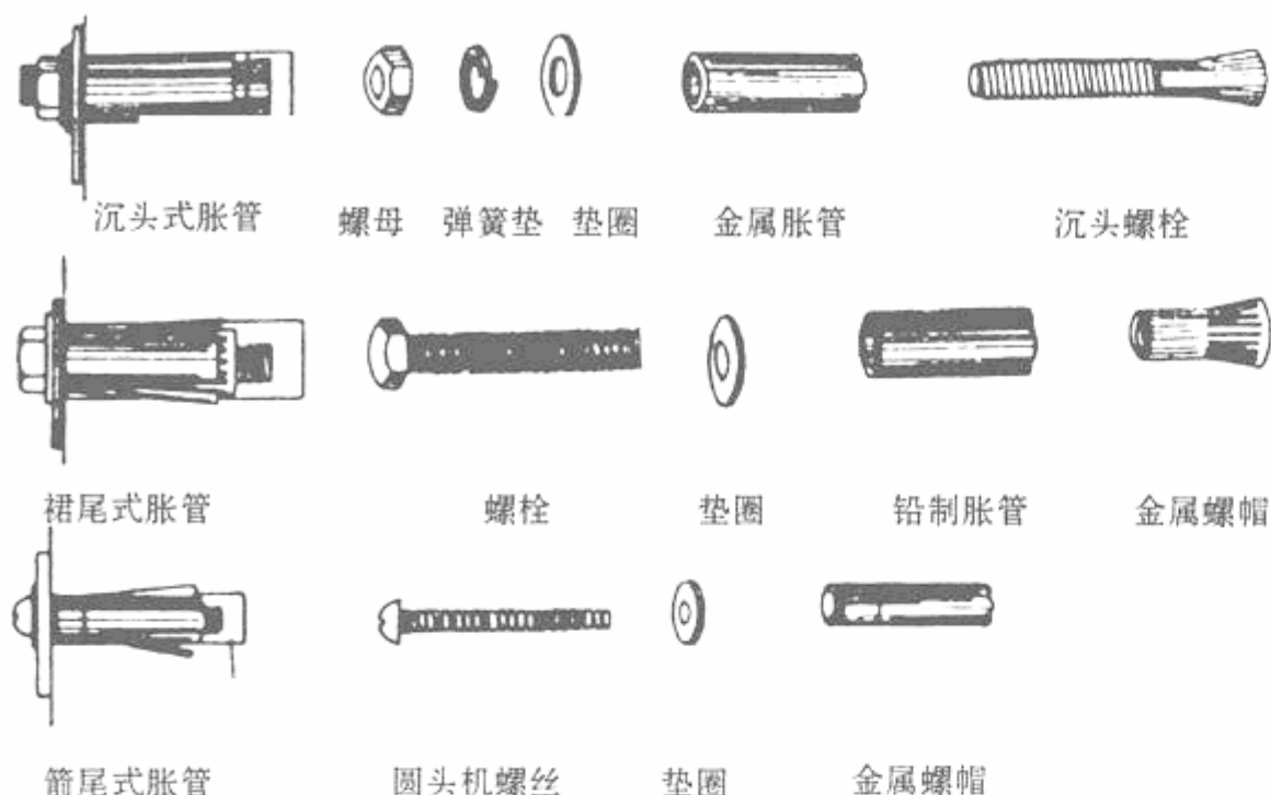
图 10-54 膨胀螺栓形状及组成
