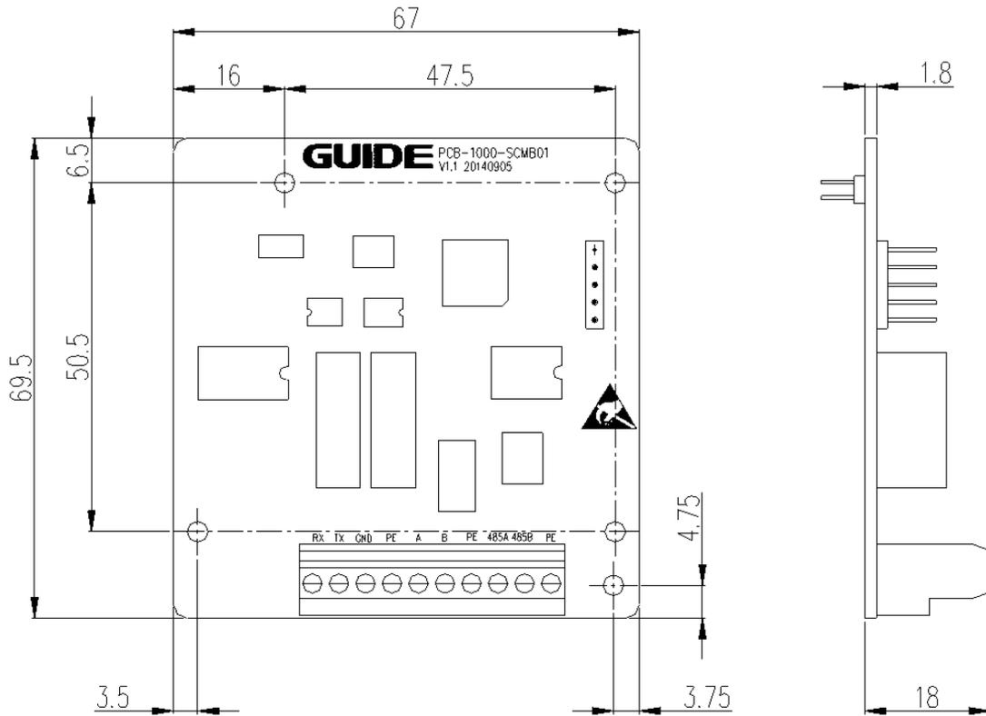
图1 GDHF-MB01 通讯卡尺寸 (单位 mm)
