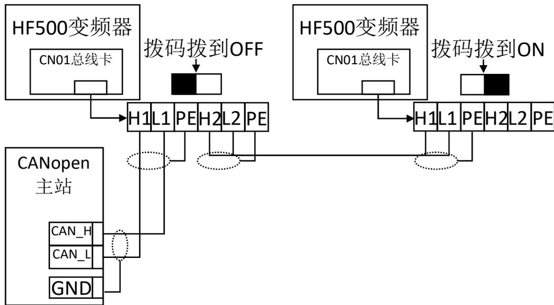
图4 标准 CANOpen 电缆接线图
