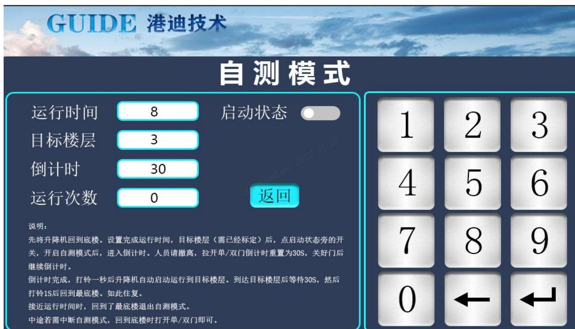
1. 输入运行时间，单位：小时。输入已经标定的楼层。（自测模式下，会在输入的楼层和下限位之间来回运行）
