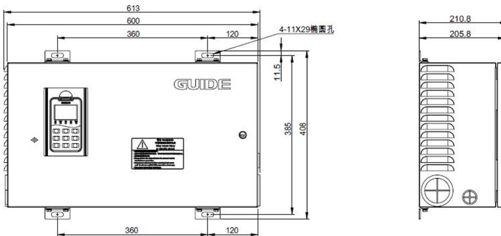
HF632N-037-4-C 型号施工升降机外形尺寸图
