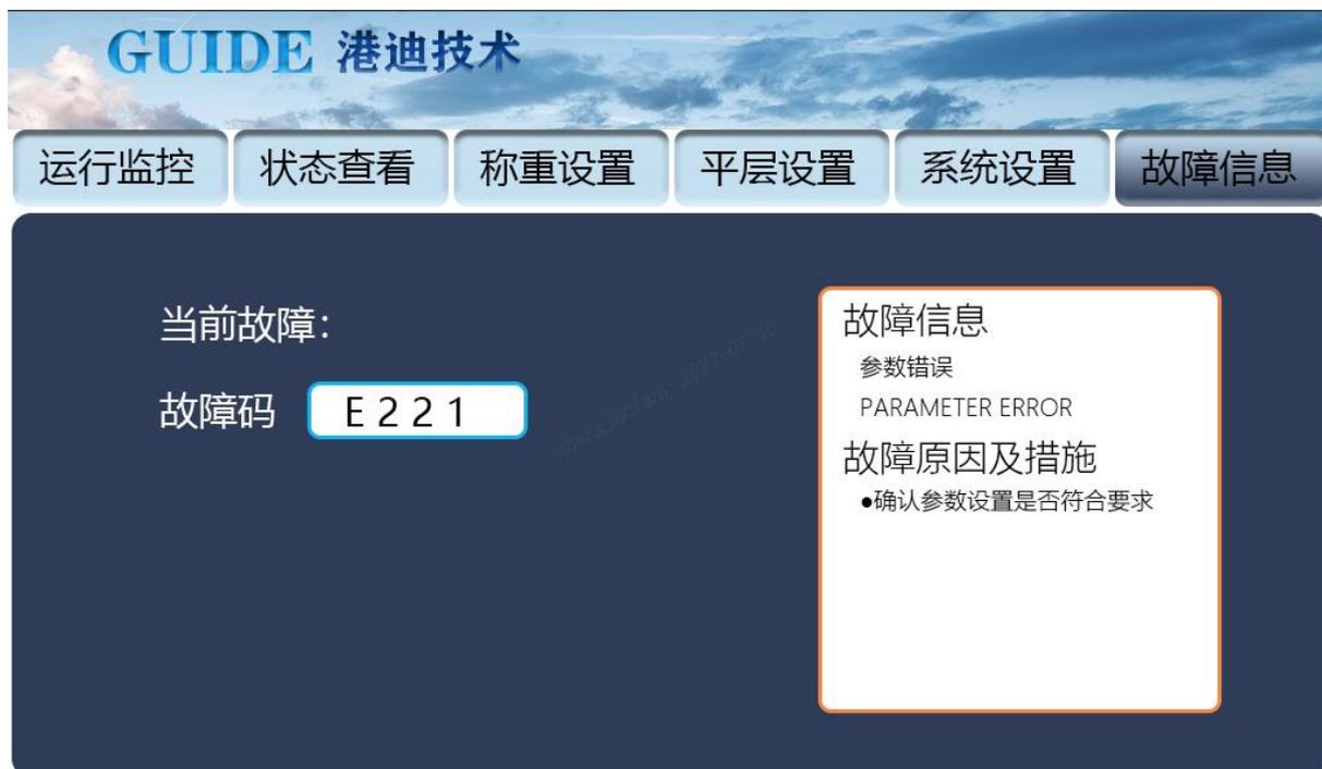
1. 升降机出现故障时，显示故障码，并显示对应的处理方法。
