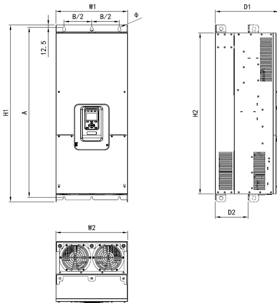
N7~N9 机型尺寸及安装尺寸示意图
