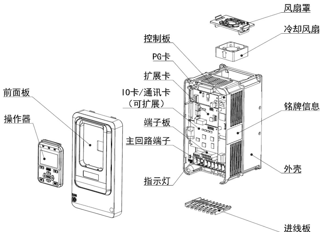
N1&N2 产品部件示意图 (三相 380V~480V, 0.4kW~11kW)
