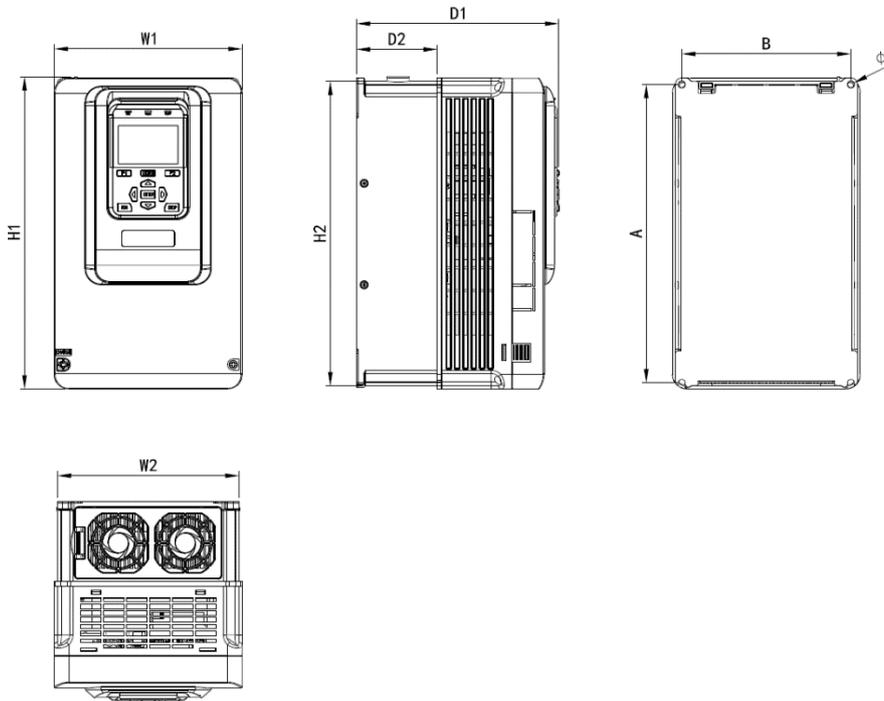
N3 机型尺寸及安装尺寸示意图
