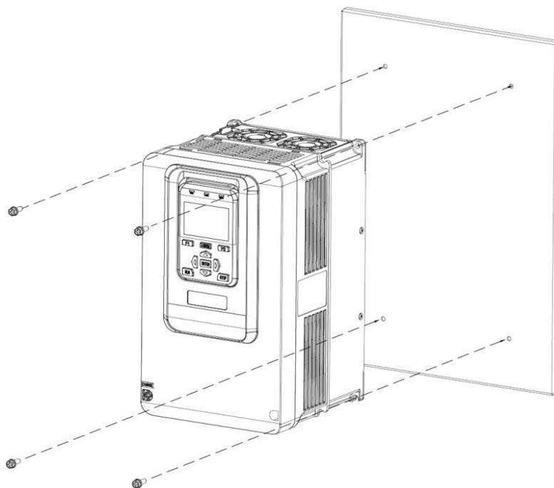
(2) 嵌入式安装 (适用于所有外形尺寸的变频器)
