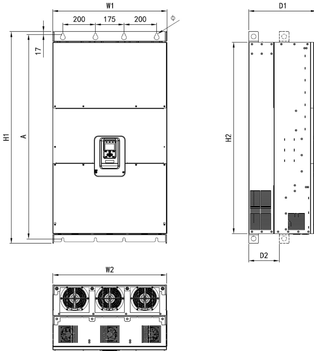
N10 机型尺寸及安装尺寸示意图
