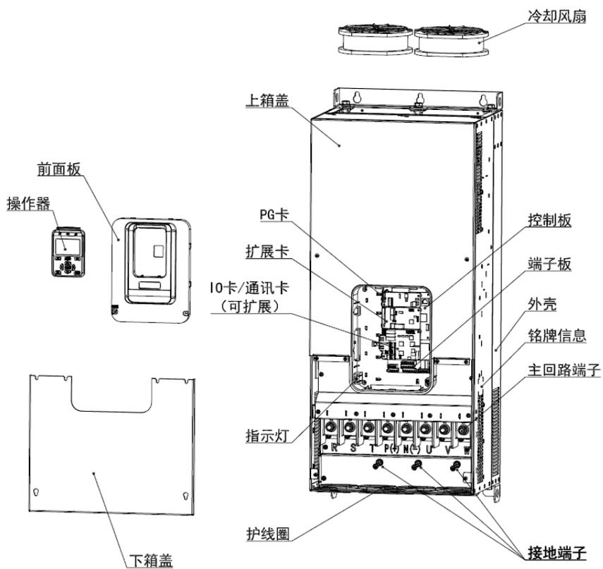
N7 产品部件示意图 (三相 380V~480V, 132kW~160kW)
