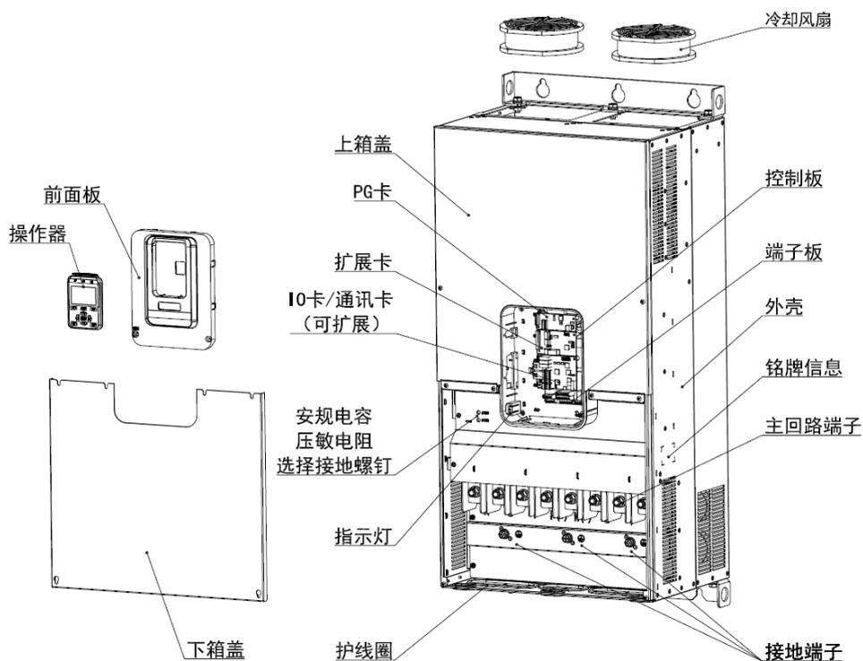
N8 产品部件示意图 (三相 380V~480V, 185kW~220kW)
