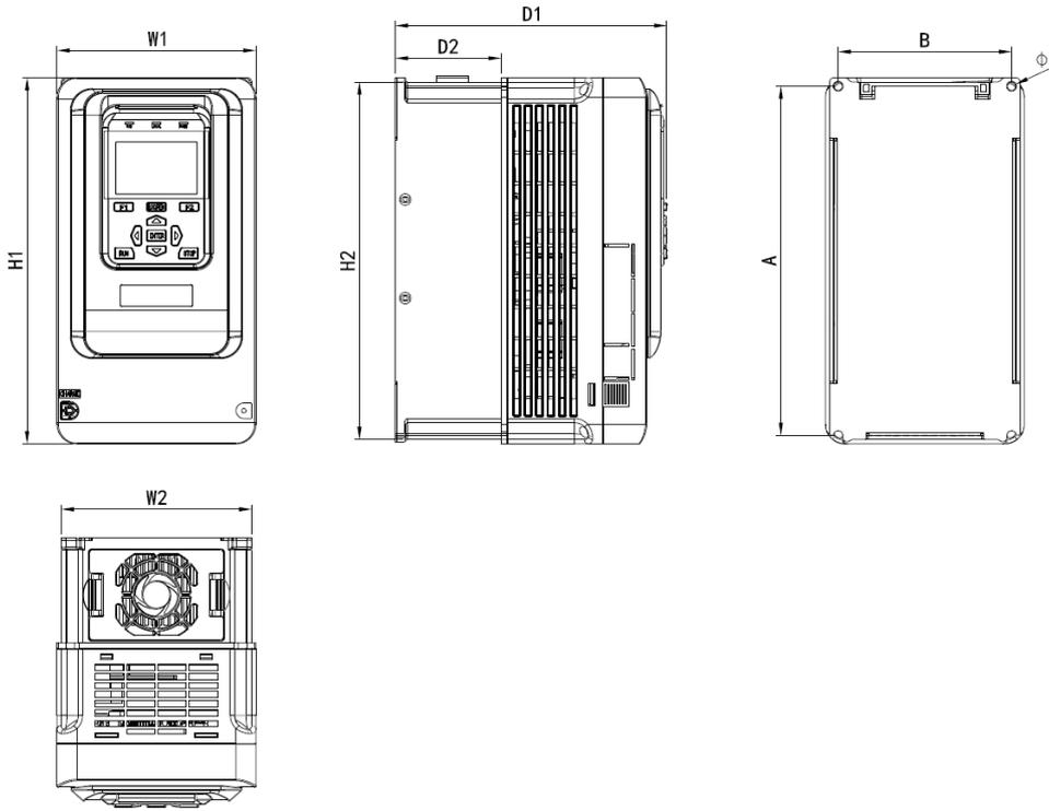
N1~N2 机型尺寸及安装尺寸示意图
