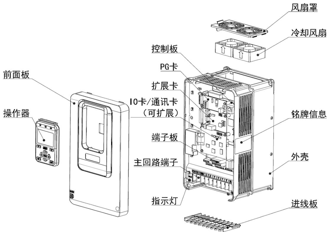
N3 产品部件示意图 (三相 380V~480V, 15kW~18.5kW)
