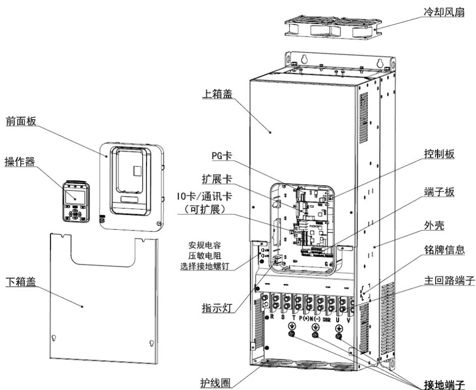
N6 产品部件示意图 (三相 380V~480V, 90kW~110kW)
