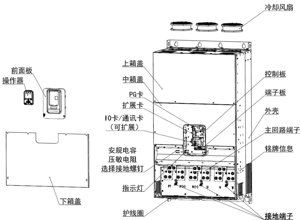
N10 产品部件示意图 (三相 380V~480V, 315kW~450kW)
