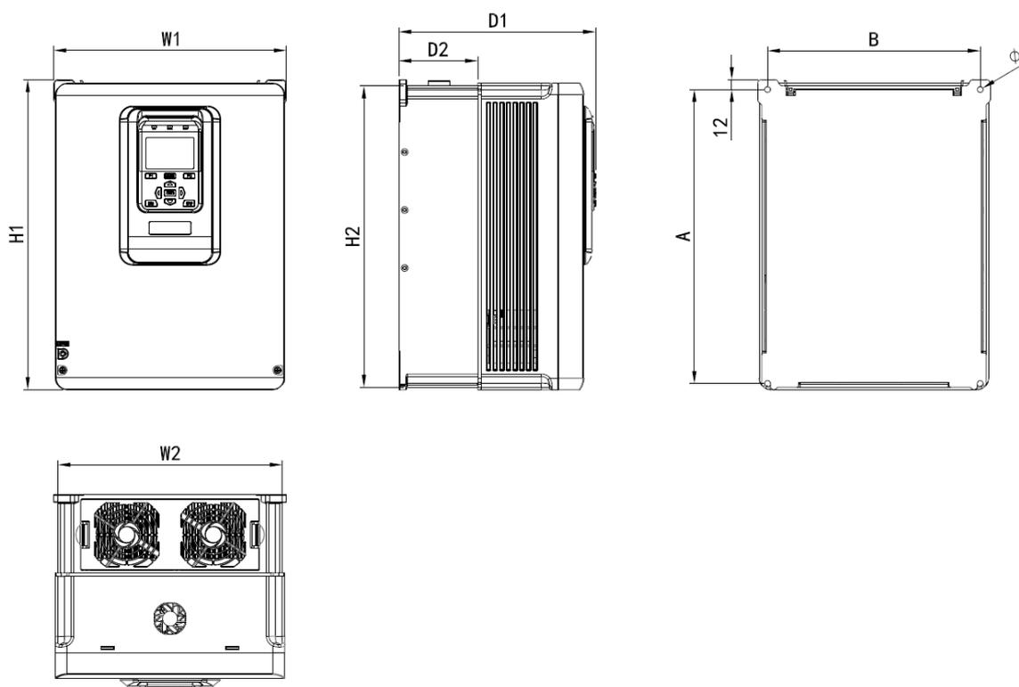
N4 机型尺寸及安装尺寸示意图
