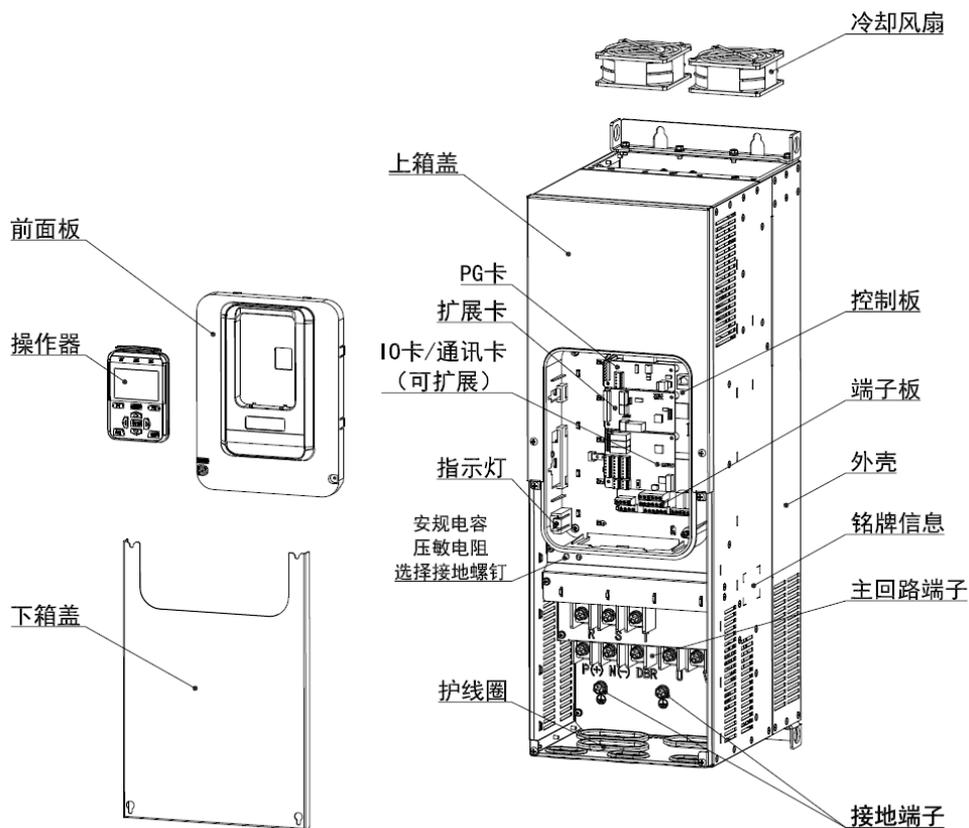
N5 产品部件示意图 (三相 380V~480V, 45kW~75kW)
