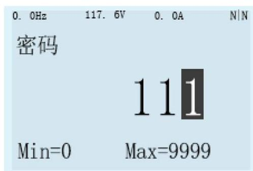
步骤 2: 进入“功能设置”菜单，选择出现的“密码”选项，按下“ENTER”进入，输入正确密码后（初始密码 000），按下“ENTER”显示“成功！”。
