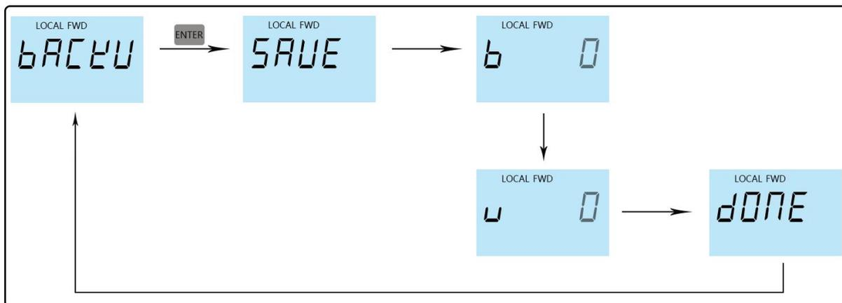
**RECOV:** 将面板的参数导入到DSP中，r表示在覆盖导入参数，b表示备份DSP面板参数，v表示核对检验导入的参数。三步骤没问题则表示导入参数完成。操作流程如下图：
