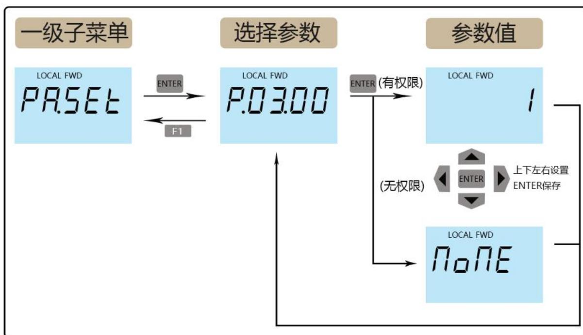
**QK.SET:** 用来快速设置常用的变频器参数，点击 ENTER，显示确认对话框：YES？，点击 ENTER 确认后，显示参数号并进入参数值设置画面，使用左键、上键、下键可以修改参数值，点击 ENTER 保存修改后的参数值，并进入下一个参数号；在该功能中，参数数据输入画面下，点击 ESC 键，将退出整个快速设置功能。操作流程如下图：
