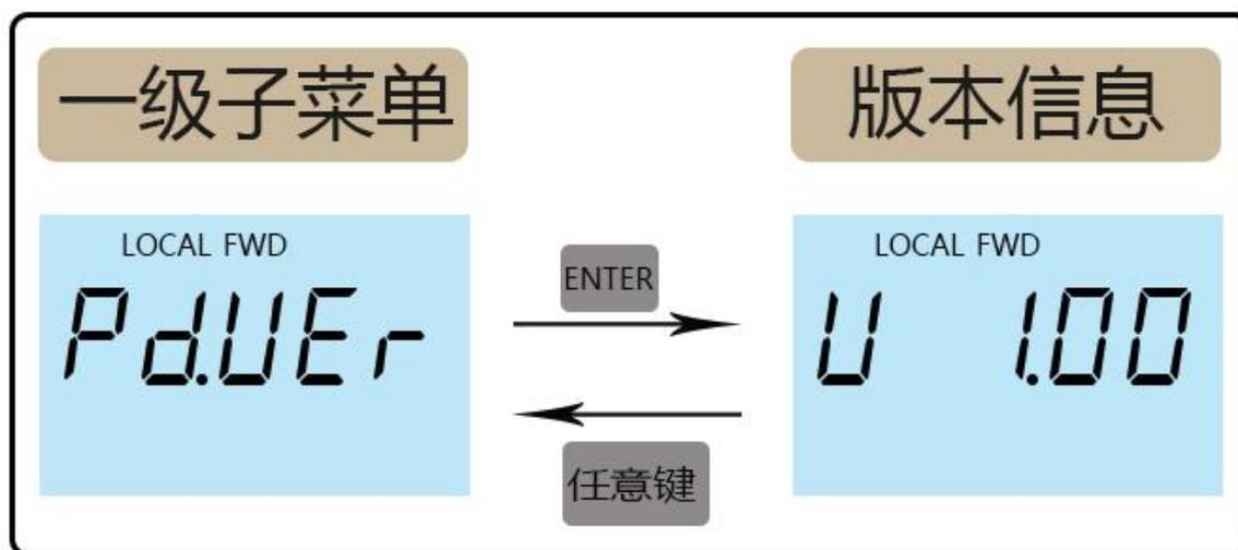
**BACKU:** 用来备份DSP的参数，b表示备份DSP的参数到面板，v表示面板备份的参数和DSP参数和对检验。完成后则备份参数成功。将其备份到面板中，操作流程如下图：
