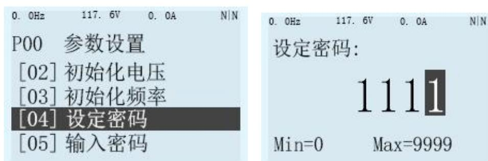
步骤 4: 若需要进行设置参数修改，需进入“P00 参数设置”选择“输入密码”，输入密码需与 P00.04 的设定密码一致才能修改参数，否则会出现参数修改无效提示。
