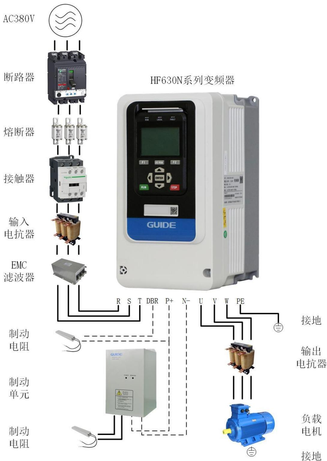
HF630N 变频系统外围电气元件的使用说明
