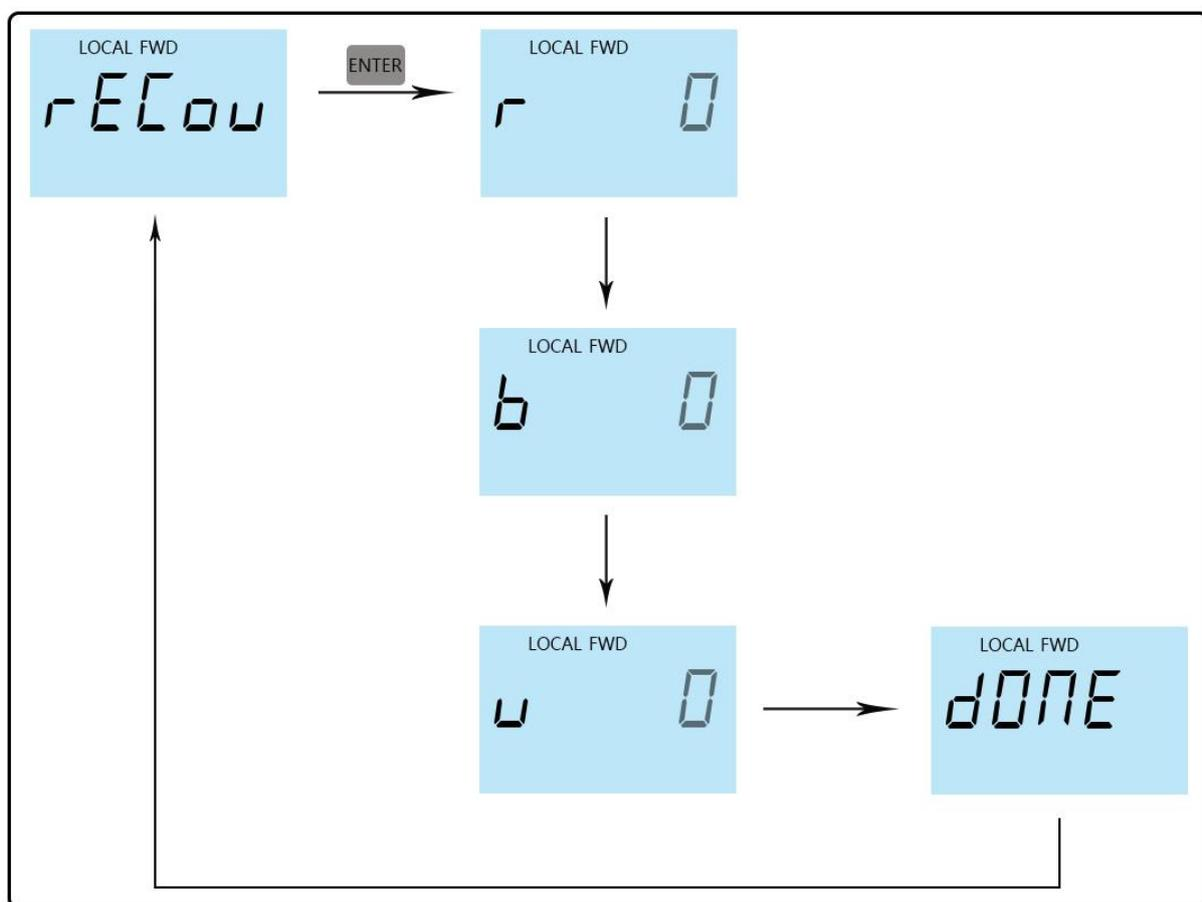
**COMP:** 比较面板和DSP的参数，有不一样的显示参数组。操作流程如下图：
