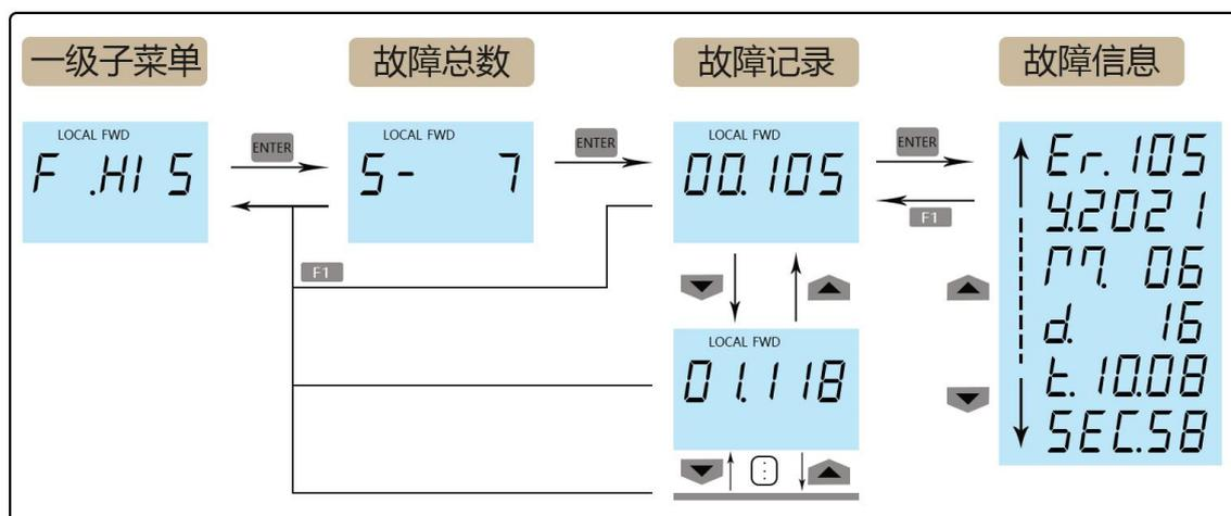
**F.CLR:** 用来删除变频器中保存的历史故障，点击 **ENTER** 键进入后，显示确认对话框：**YES ?**，点击 **ENTER** 键确认，并开始执行删除操作，执行完毕后，屏幕显示：**DONE**；点击其他键，为取消该操作，屏幕显示：**CANCE**。操作流程如下图：
