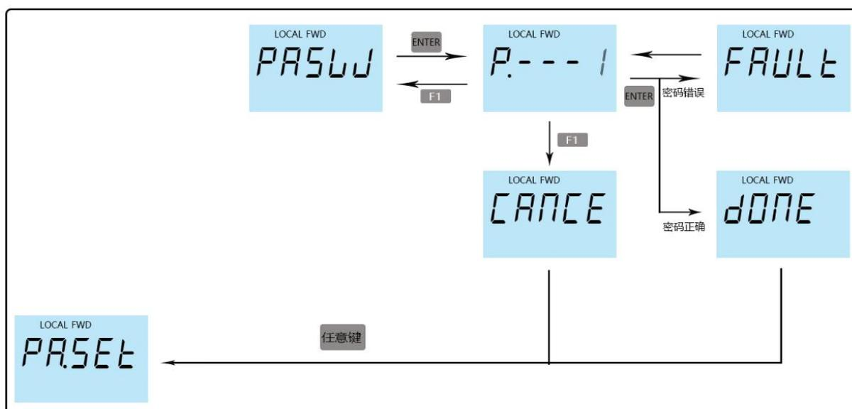
**P.LOCK:** 高级权限锁定。点击 ENTER 键确认，将取消参数访问的高级权限，更改为普通权限。当无按键操作超时，即背光关闭时间设置值的一半，屏幕会切换到主菜单，同时参数访问权限也更改为普通权限。执行完毕后，会跳转到 PA.SET 画面，操作流程如下图：
