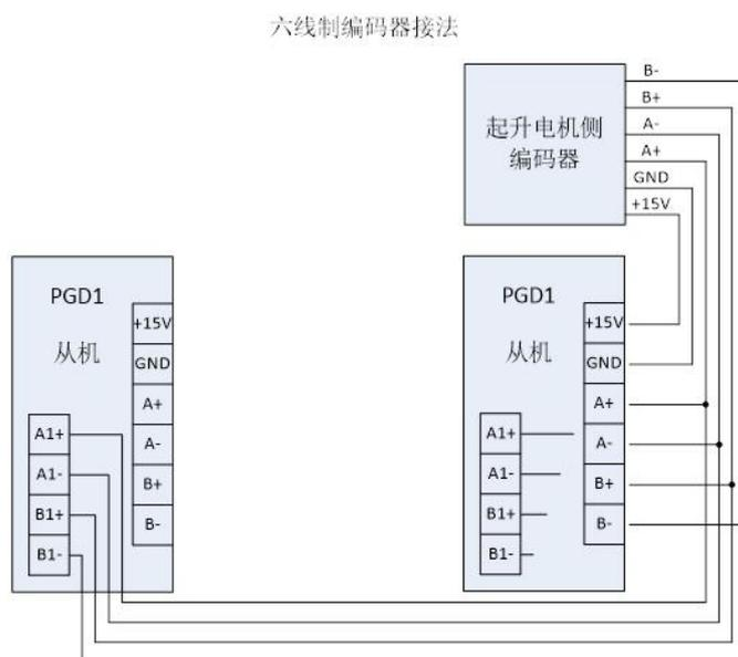
根据实际情况设置旋转或变幅变频器 P20.14 编码器脉冲数的值。运行起升机构，通过上位机观察旋转或变幅变频器的 101.64 和 101.65 的值，确认编码器线已接好。
