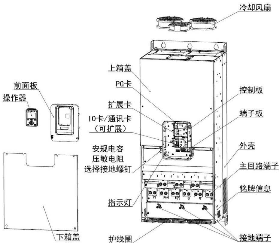
N9 产品部件示意图 (三相 380V~480V, 250kW~280kW)
