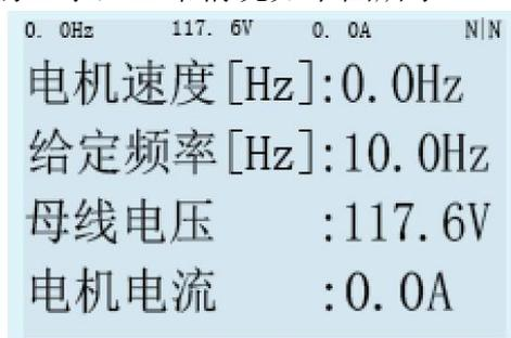
故障发生时，与上述所示不同。右上角 Warning/Error 处会有对应的图标显示，出现故障会显示 N | E，如果还有警告，则会显示 W | E。
