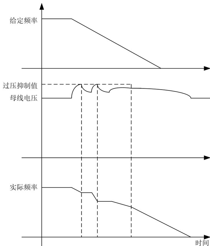
P7.71 设为使能时，软件自动调整减速时间和增加励磁来实现过压抑制；P7.71 设为禁止时，软件自动调整减速时间来实现过压抑制。
