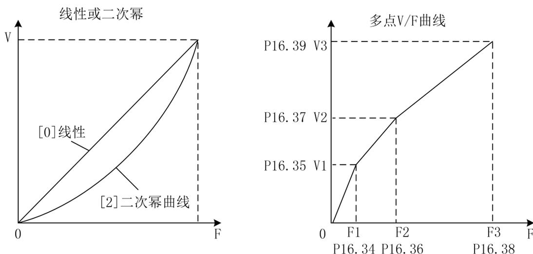
P16.34~P16.45 十二个参数定义多点 V/F 曲线。V/F 曲线的设定值通常根据电机的负载特性来设定。注意： $V1 < V2 < V3$ ， $F1 < F2 < F3$ 。低频电压设定过高可能会造成电机过热甚至烧毁，变频器可能会失速或过电流保护。
