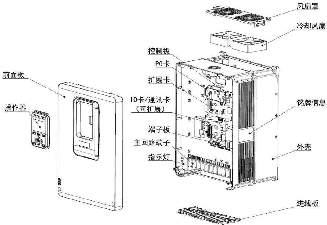
N4 产品部件示意图 (三相 380V~480V, 22kW~37kW)
