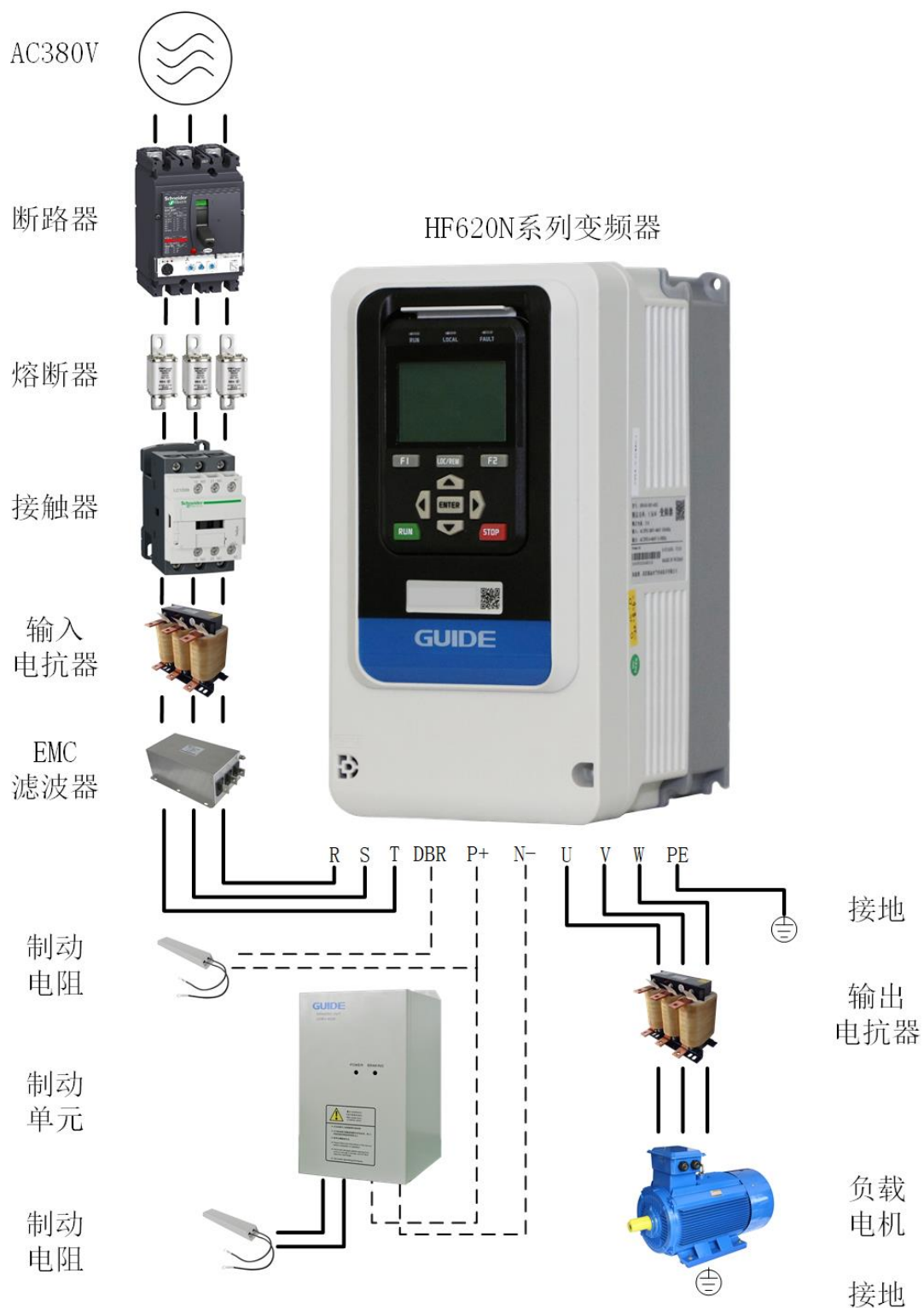
HF620N 变频系统外围电气元件的使用说明
