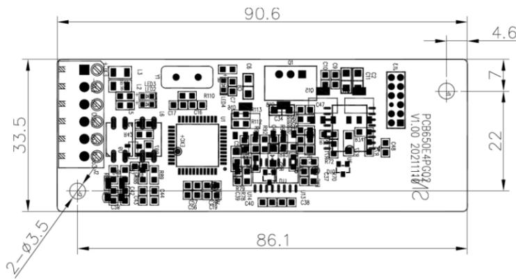
图 1 旋变 PG 卡外形尺寸
