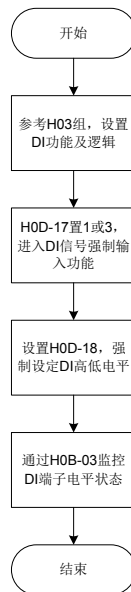
图 5-5 DI 信号强制输入设定步骤示意图
