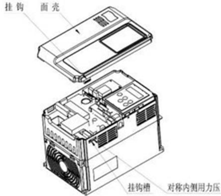
图4-2 塑胶外壳下盖板拆卸图
