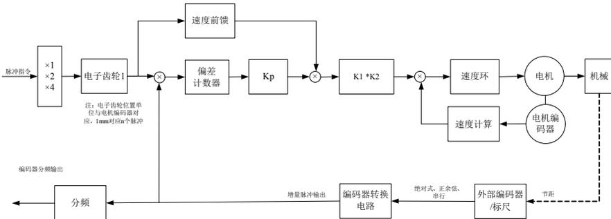
与内部位置闭环不同，使用全闭环功能时必须外部位置闭环的工作方式（功能码H0545），具体如下：
