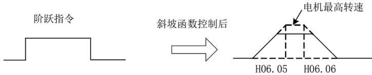
伺服电机的加减速斜坡时间是由电机从零速度加速到最高速度的时间或从最高速度减速到零速度的时间决定的，实际的加减速时间计算公式如下：
