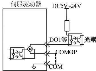
伺服驱动器内部光耦输出电路最大允许电压、电流容量如下:
