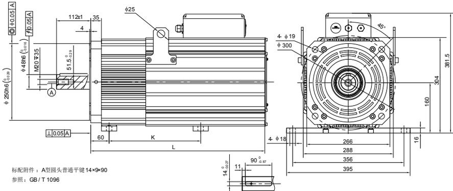
图3-4 伺服电机外形及安装尺寸图 (实心轴、强制风冷ISMG2)
