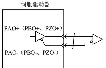
下面就用户接口连接器集电极Z相分频输出信号端子进行说明。
