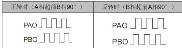
当编码器反馈脉冲输出信号与上位机指令方向不同，可以通过更改伺服电机旋转方向选择功能码H02-02和输出脉冲反馈方向选择H02-03进行调整。
