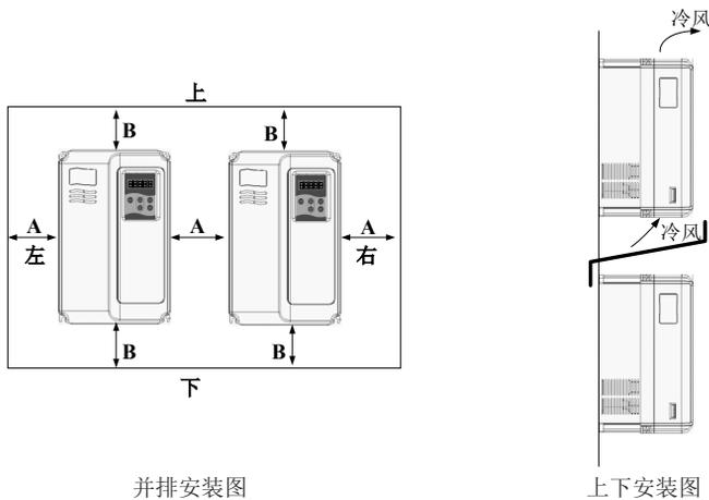
图4-1 伺服驱动器机械安装图
