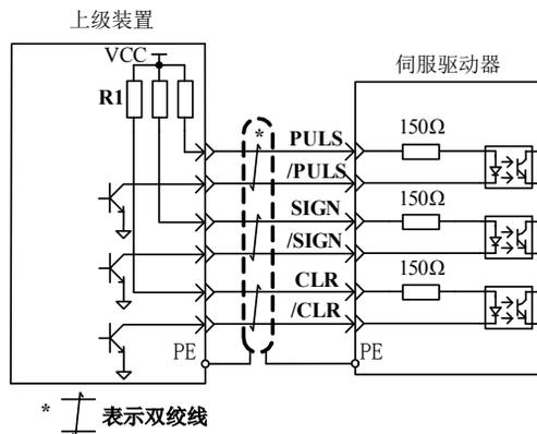
请选择限流电阻R1的值，务必使输入电流保持在6~10mA范围内。
