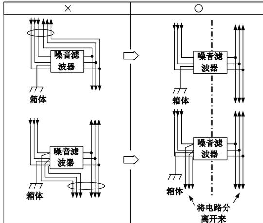
2) 将噪音滤波器的地线与输出配线分离走线。
