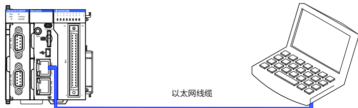
图 11 CPU 模块与 PC 连接
