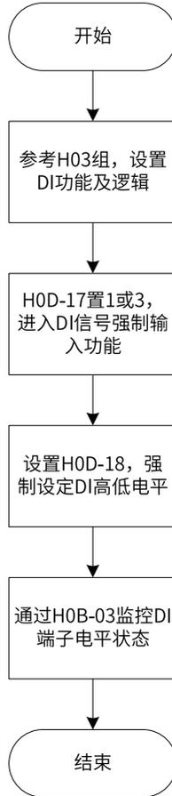
图2-3 DI信号强制输入设定步骤示意图
