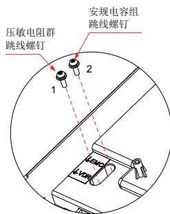
图 3-35 压敏电阻 (VDR)、安规电容 (EMC) 对地跳线位置示意图
