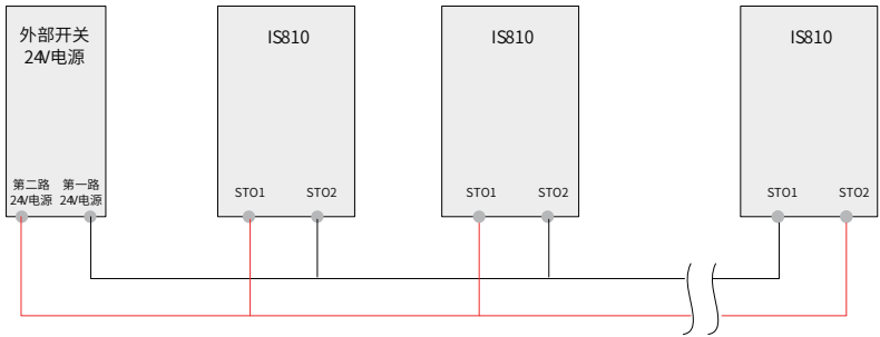
图 3-23 多台 STO 端子级联共用 24V 电源接线示意图
