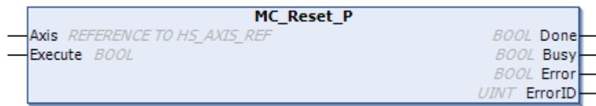
图 6-23 MC\_Reset\_P 功能块示例图
