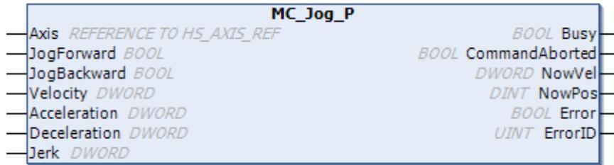
图 6-17 MC\_Jog\_P 功能块示例图
