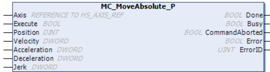
图 6-19 MC\_MoveAbsolute\_P 功能块示例图
