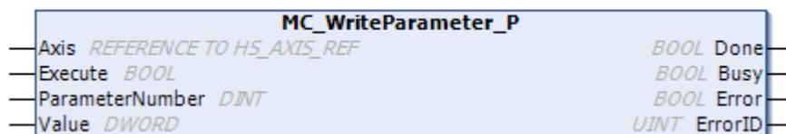
图 6-26 MC\_WriteParameter\_P 功能块示例图
