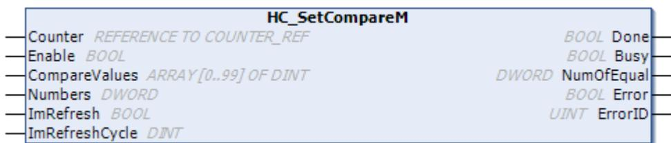
图 6-12 HC\_SetCompareM 功能块示例图
