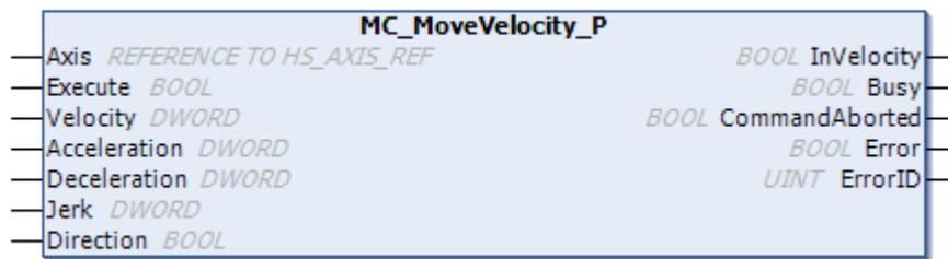
图 6-21 MC\_MoveVelocity\_P 功能块示例图
