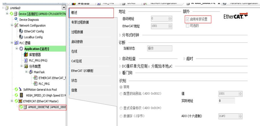
步骤 2: 点击【设备】-【在线】，在【状态机】中选择“引导”。进入引导状态后，选择【通过 EtherCAT 进行文件访问】-【下载】。在弹出的框中，找到要升级的后缀名为“.bin”固件文件路径，选中固件文件启动升级。
