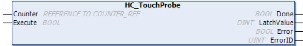
图 6-5 HC\_TouchProbe 功能块示例图
