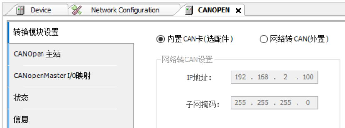
图 3-56 图 CANopen 外置模块配置界面
