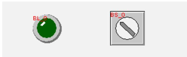
修改位状态指示灯控件一般属性，设置地址为 Q\_bit(0:0)。
