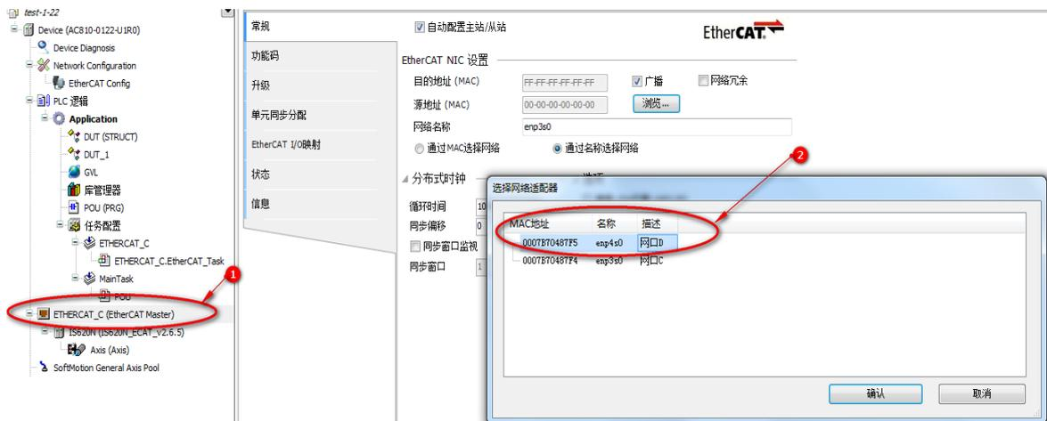
EtherCAT 总线正常启动后，若用户退出登录，在线执行“扫描设备”时扫描结果可能会失败或者不准确。原因是“扫描设备”过程中以 SDO 通讯方式读取从站信息（例如对象字典 0xF050）可能超时，导致影响扫描结果（SDO 通讯属于异步通信，CPU 负载、总线循环周期、用户程序执行时间都会影响 SDO 通讯）。
