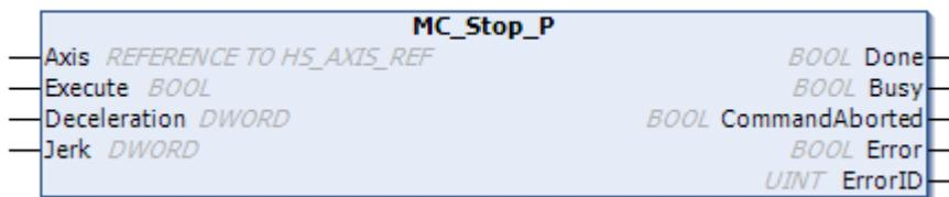
图 6-22 MC\_Stop\_P 功能块示例图
