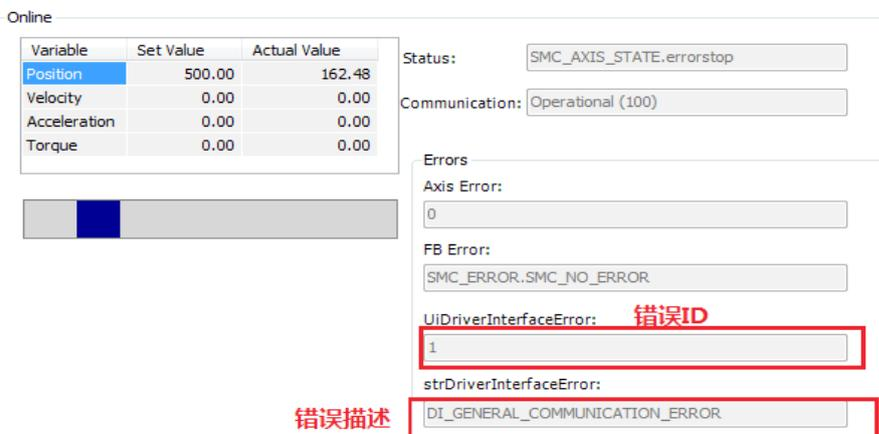
图 6-34 CANopen 轴在线诊断
