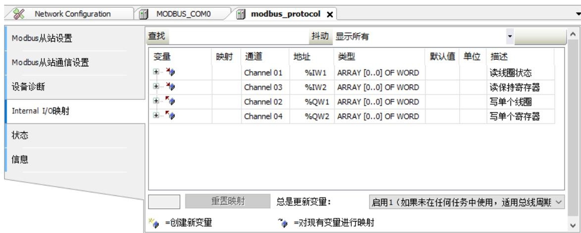
图 3-35 端口做主站时的 Modbus 从站 Internal I/O 映射
