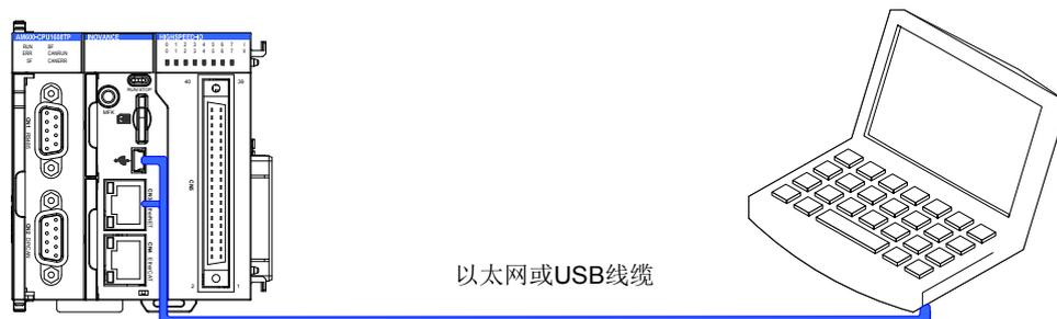
图 1-4 InoProShop 软件与硬件连接示意图
