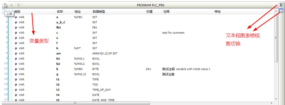
图 4-2 表格视图声明编辑器
