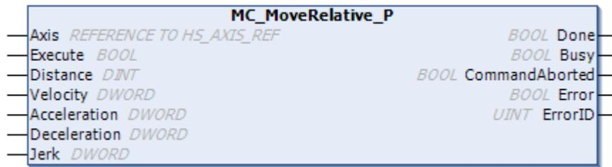
图 6-20 MC\_MoveRelative\_P 功能块示例图
