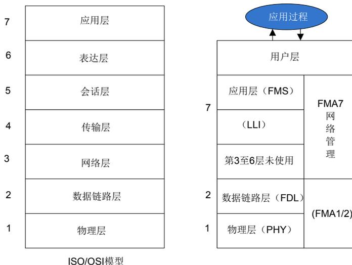
图 3-82 PROFIBUS-DP 现场总线模型
