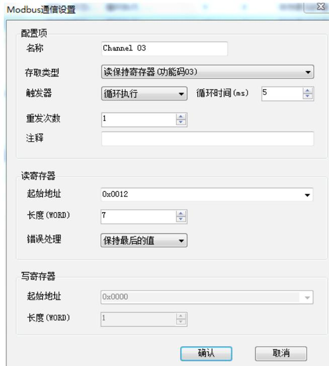
图 3-45 Modbus TCP 主站连接 Modbus TCP 从站通信设置对话框
