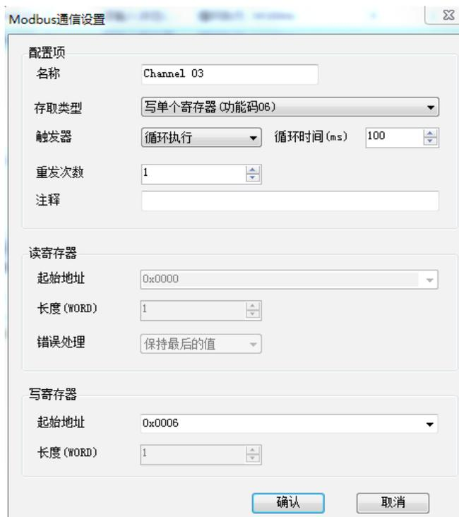
图 3-34 端口做主站时连接 Modbus 从站通信设置对话框
