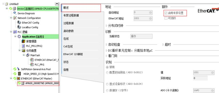
步骤 2: 点击【设备】-【在线】-【写 EEPROMXML】，在弹出的框中，找到要升级的 XML 文件的路径，选中该文件后启动升级。
