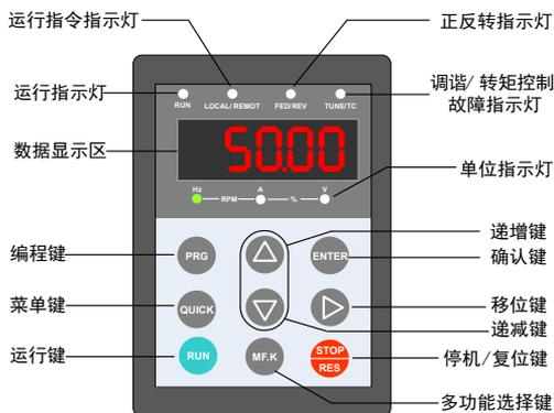
图 3-1 操作面板示意图
