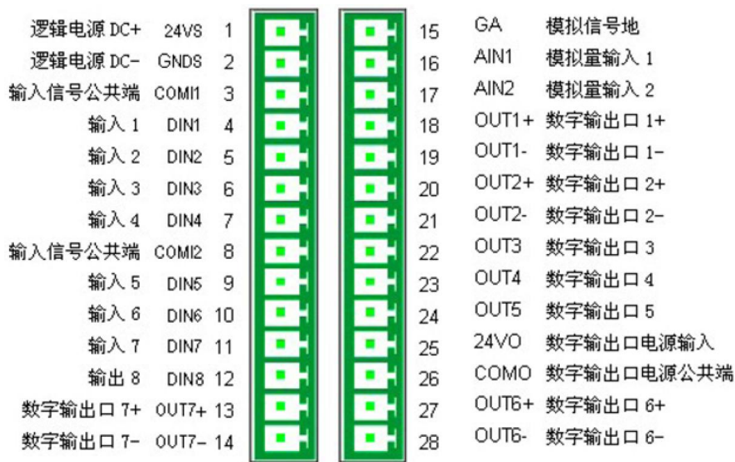
图 3-2 JD 驱动器 I/O 接线端子定义图
