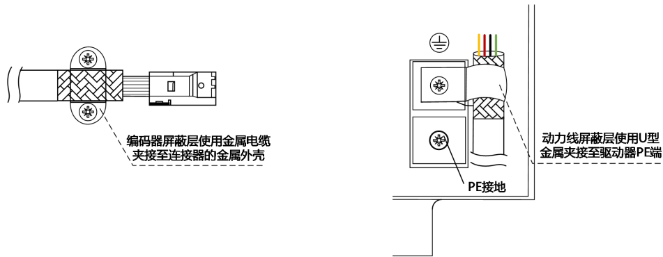
图 3-9 驱动器侧动力线/编码器线屏蔽层 1*处理方式
