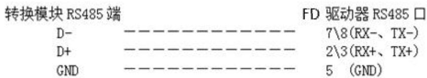
附图 6-5 RS485 连接方式图
