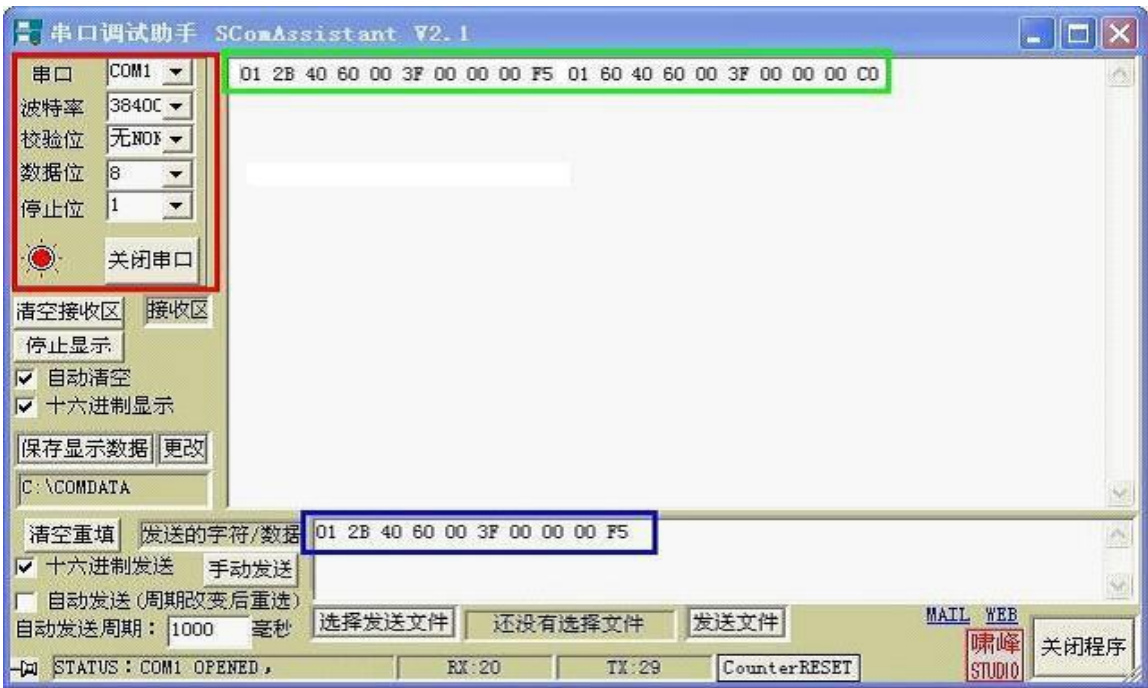
附图 7-6 d5.15=1 时开启 RS232 级联通讯时发送示例
