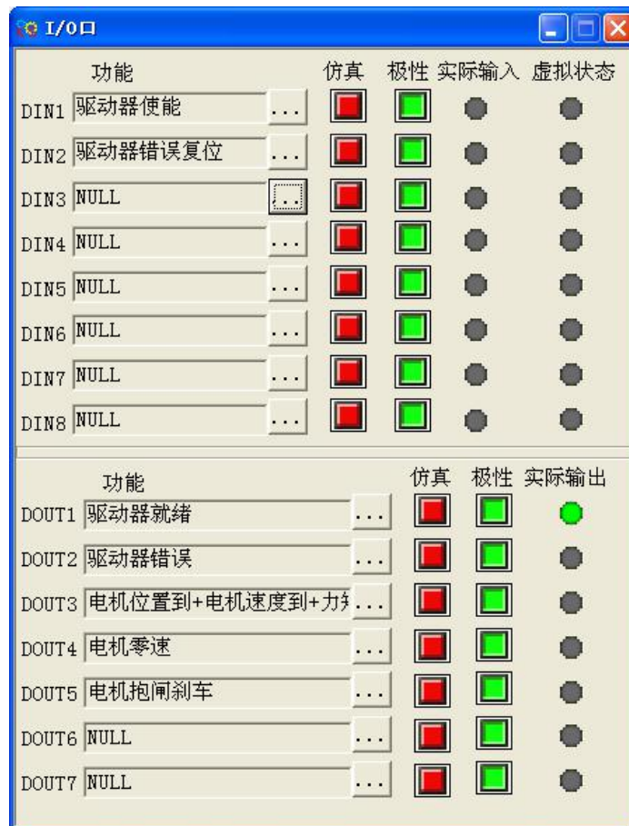
图 6-4 模拟速度模式 I/O 参数设置
