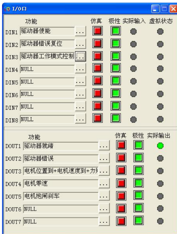
图 6-15 脉冲模式 I/O 参数设置
