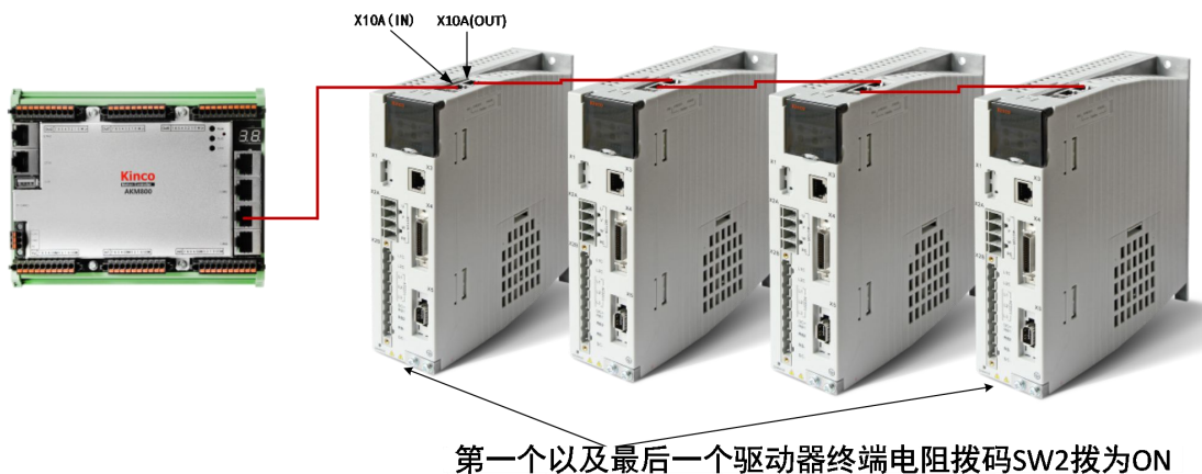
图 10-6 驱动器终端电阻配置方式
