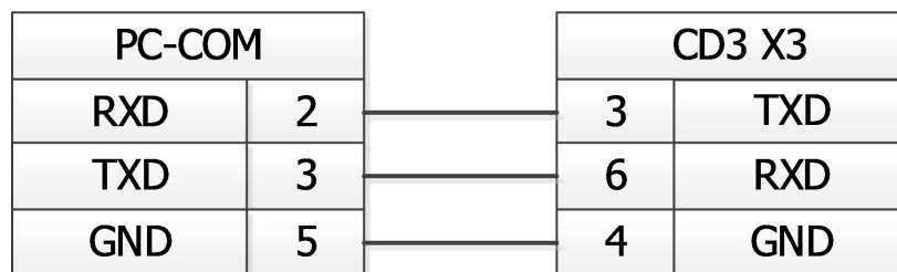
图 10-1 电脑 USB 接口和 CD3 驱动器 RS232 接口连接方式
