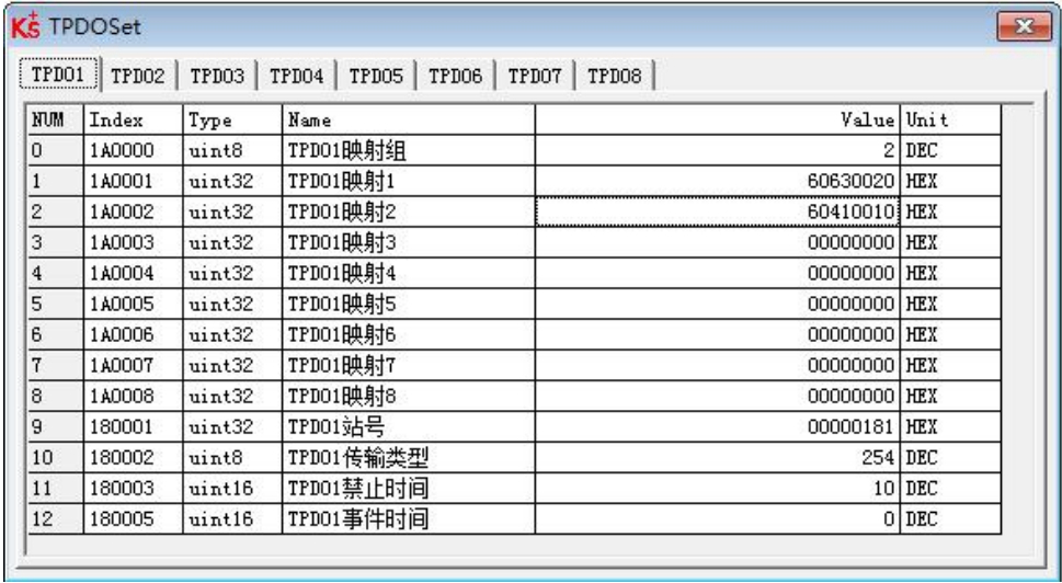
图 11 - 7 异步传输模式下 TPDO 配置
