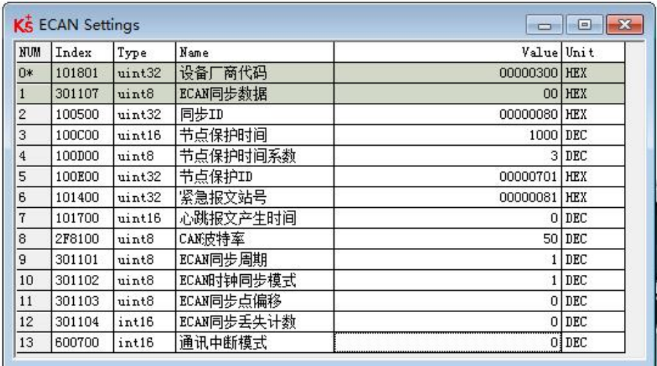
图 11 - 10 插补模式相关参数设置
