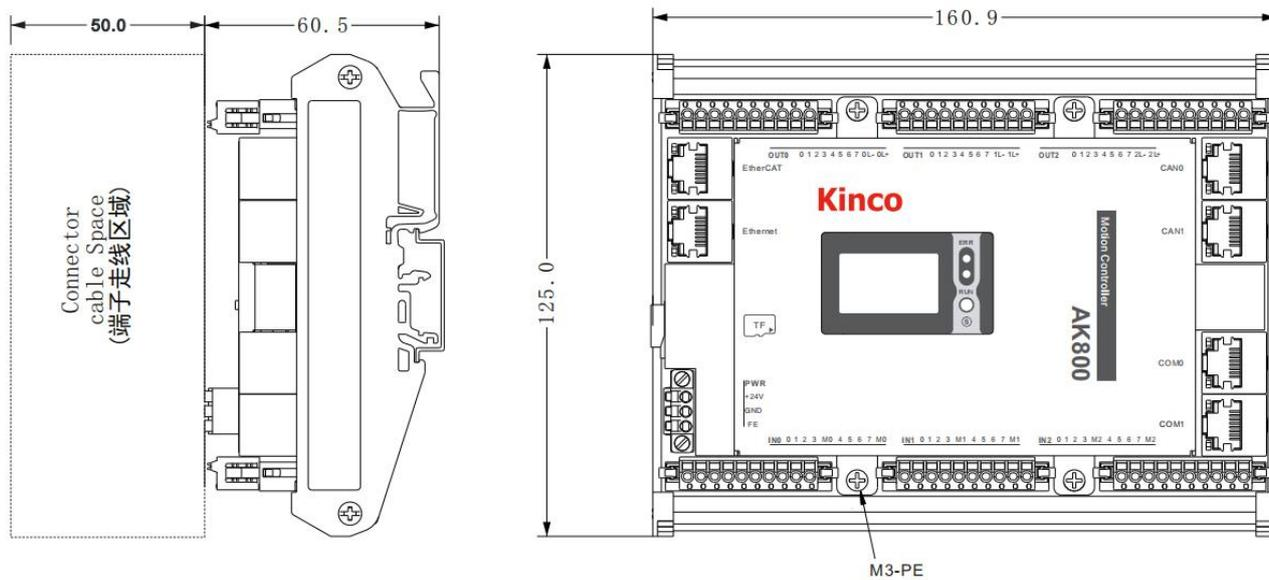
图 3.10-01: AK800 系列控制器外观尺寸示意图 (mm)
