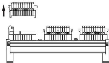
2. 用力捏住端子座卡扣后，将端子往上拔
