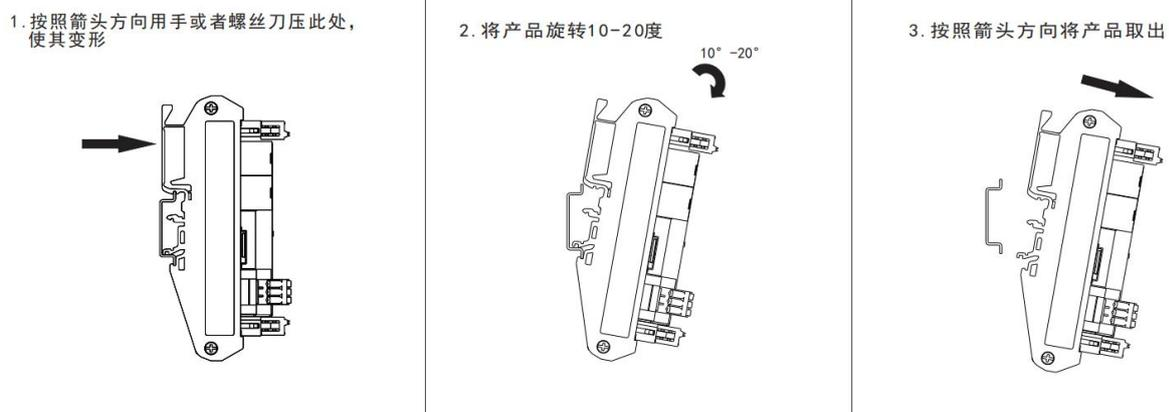
图 4.2-03：产品拆卸步骤
