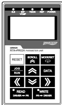
设定驱动器参数进行控制运转时,或希望进行参数拷贝时需要使用参数控制单元。
