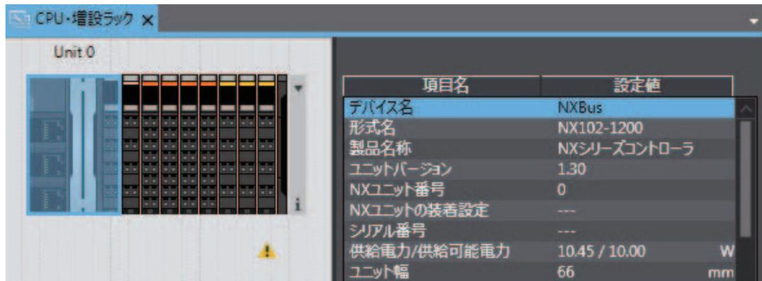
此外，Sysmac Studio 中未考虑 I/O 电源供给的设计条件。请参考「4-3-2 从 NX 总线供给时 I/O 电源的设计方法(P.4 - 10)」，进行实际设计。
