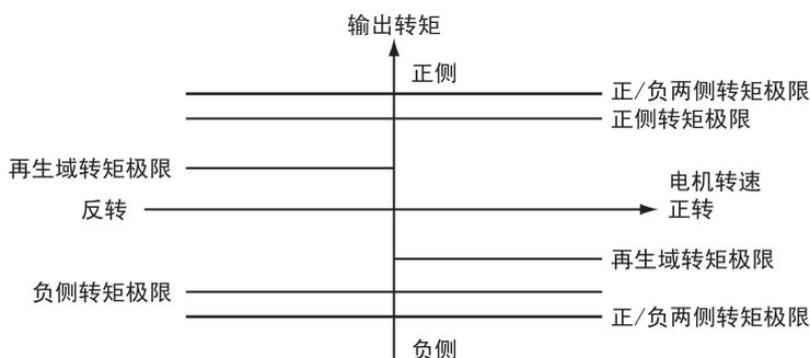
图 6.36 来自模拟量输入的转矩极限
