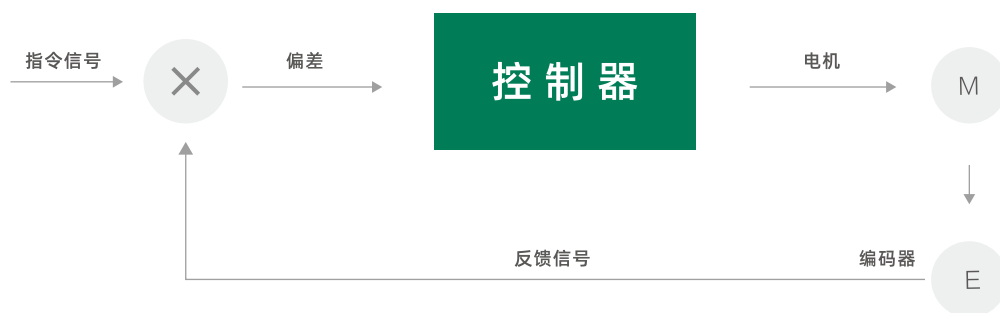
闭环步进驱动控制原理图
