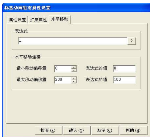
图 1-2-4 水平移动属性设置
