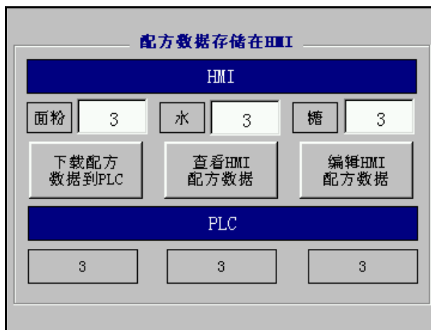
图 3-1-2 配方存储于 HMI 运行效果
