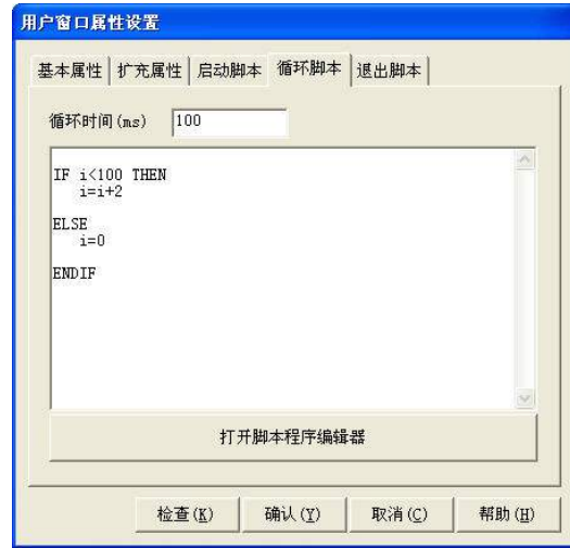
图 1-2-7 水平移动脚本设置
