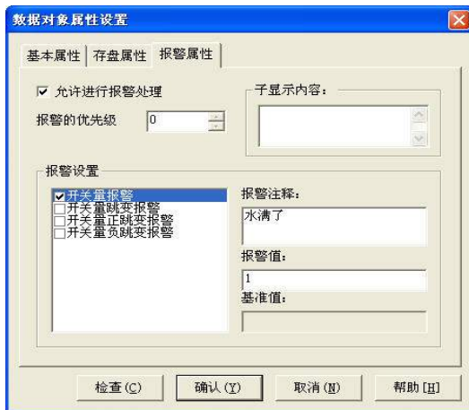
图 2-2-4 设置开关量报警
