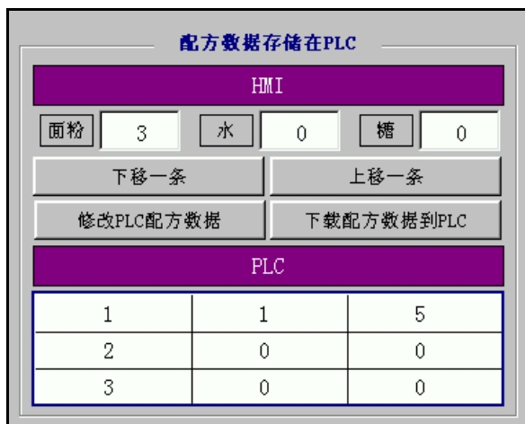
图 3-1-1 配方存储于 PLC 运行效果
