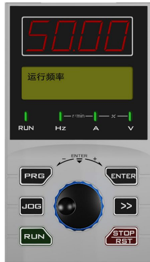
图 4-2 LED+LCD 双显键盘（键盘 B）
