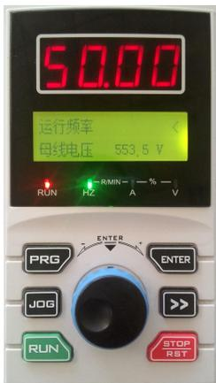
例：期望在双显键盘上，运行中始终同时观察“运行频率”和“母线电压”，如左图所示。
