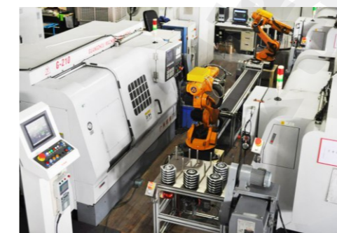
图二 电机端盖自动化生产线现场图
