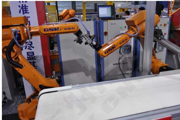
利用机器人视觉系统完成分拣搬运工作
