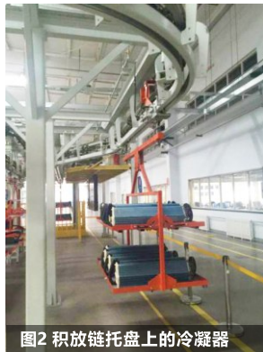
图2 积放链托盘上的冷凝器
