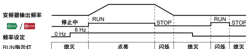
图 6.2 RUN指示灯和变频器动作的关系
