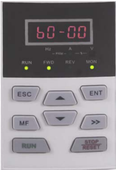
图 4-5 功能码序号编辑状态图
