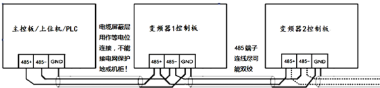
图 3-25 RS485 通讯端子连接图
