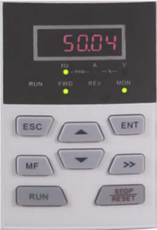
图 4-7 直接频率修改状态图
