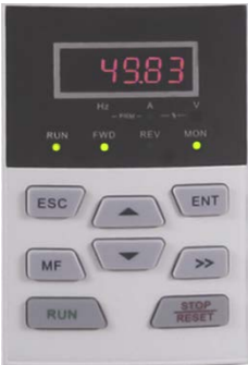
图 4-6 功能码参数设置状态图（设置 b0-02=49.83Hz）
