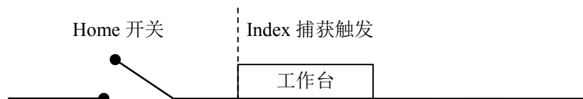
图 8-7 Home+Index 回原点示意图 4
