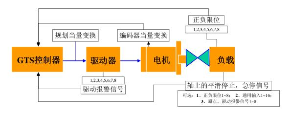
图 5-5 axis 配置对控制系统的影响
