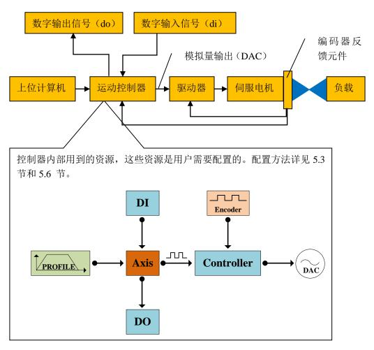
图 5-2 闭环运动控制系统的配置
