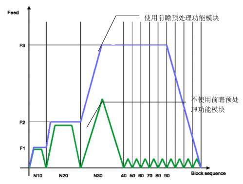
图 7-18 使用和不使用前瞻预处理功能模块的速度曲线对比图
