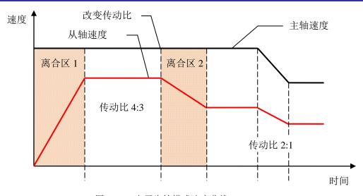
图 7-5 电子齿轮模式速度曲线
