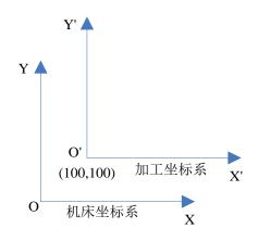
图 7-10 加工坐标系偏移量示意图
