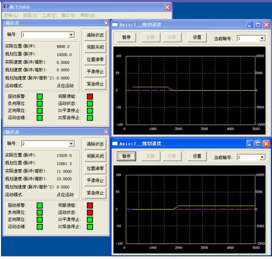
图 12-2 电机到位的运动状态检测
