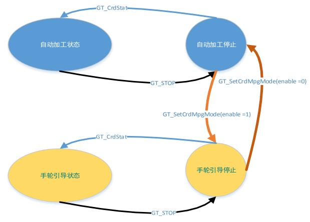
图 12-6 自动加工与手轮引导模式相互切换的状态流程
