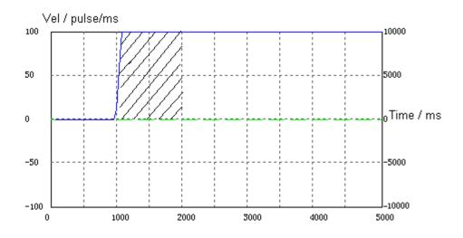
图 7-6 电子齿轮模式主轴速度规划
