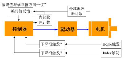
图 5-12 encoder 配置对控制系统的影响
