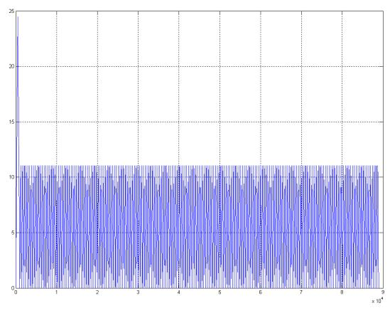
图 7-21 没有进行前瞻预处理的合成速度曲线
