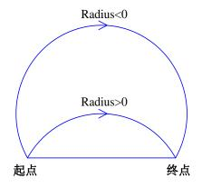
图 7-14 半径取正值/负值圆弧插补示意图
