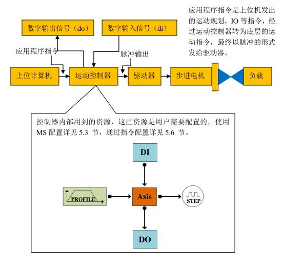
图 5-1 开环运动控制系统的配置
