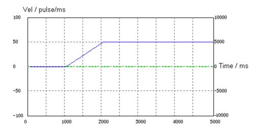
图 7-7 电子齿轮模式从轴速度规划
