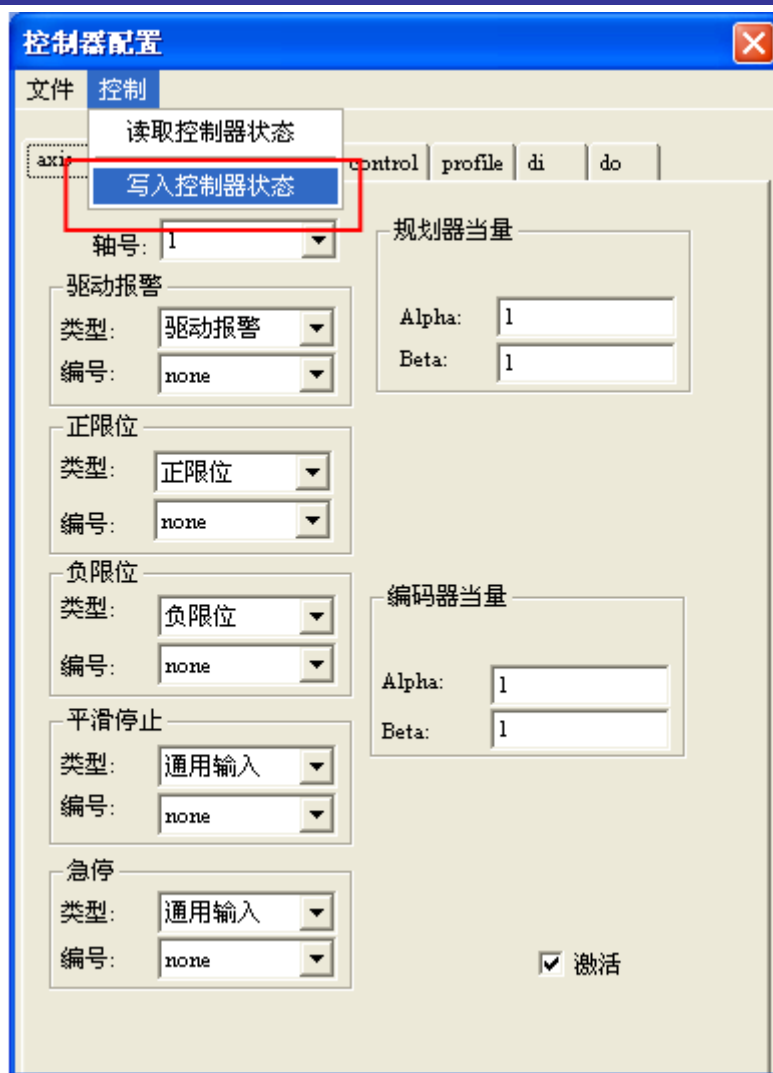
图 4-8 写入控制器状态
