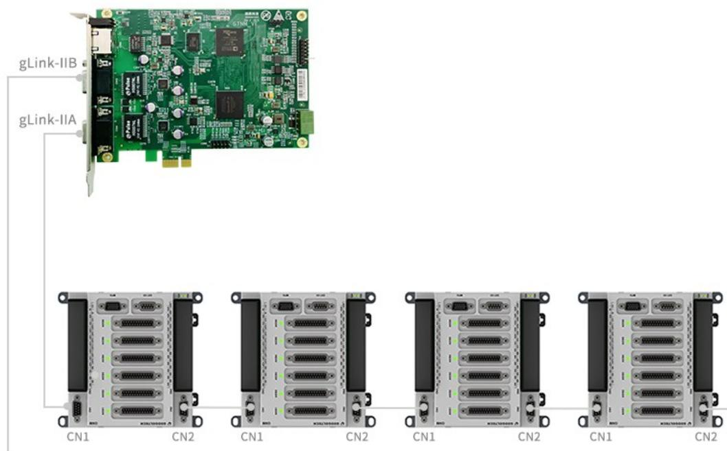
图 2-10 运动控制器与 6 轴端子板连接示意图
