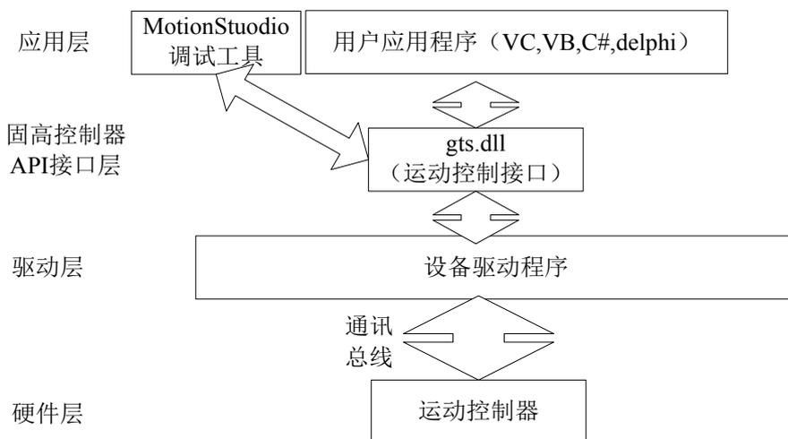
图 2-13 系统架构图
