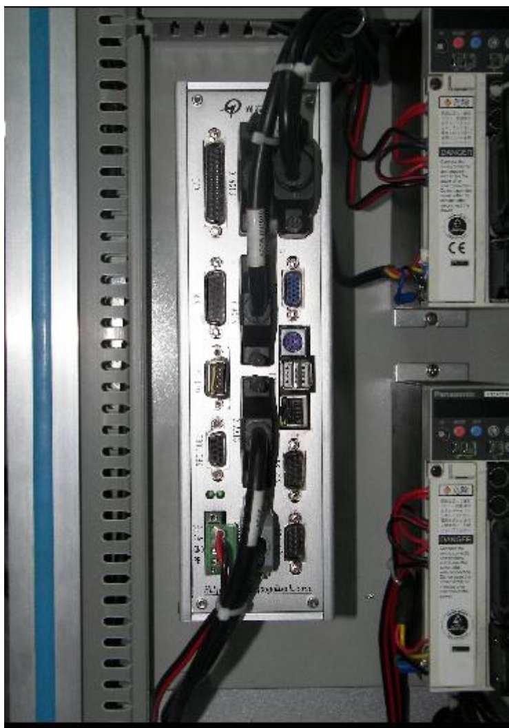
图 2-17 CPAC-Otobox 自动化控制器垂直方向安装（散热效果好）
