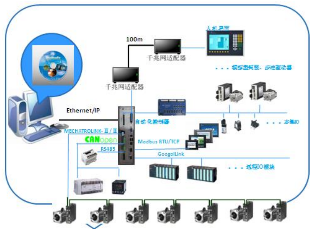
图 1-1 采用 CPAC-OtoBox 系列自动化控制器组成的控制系统框图
